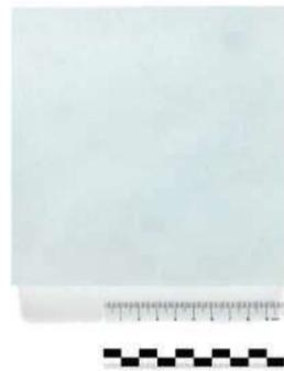
**Abb. 181** Magna Glaskeramik, transluzentes Material, kann als Wand- und Bodenfliese eingesetzt werden, oder auch als Küchenplatte
