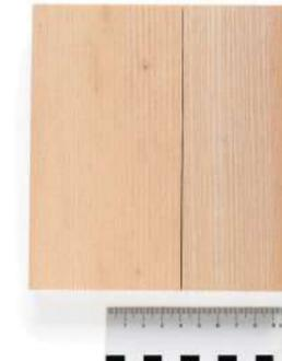
**Abb. 188** Braunkernesche besitzt eine hohe Elastizität und gute Festigkeit, als Fußboden setzt er sich aus unterschiedlich breiten Brettern zusammen, da immer der gesamte Stammquerschnitt augenutzt wird
