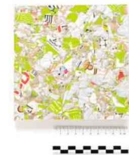
**Abb. 187** ReWall- Plattenwerkstoff aus recycelten Getränkekartons, kann als Wandfliese wie auch als Rigipsplatten-Ersatz Verwendung finden
