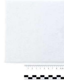
**Abb. 184** Filz kann gegen Hitze und Kälte isolieren und besitzt gleichzeitig eine schalldämpfende Funktion
