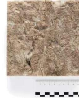
**Abb. 185** Dämmplatte aus Steinwolle
