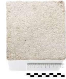
**Abb. 186** Mycofoam- Wurzelwerk von Pilzen und landwirtschaftliche Abfälle sind Ausgangsstoffe des Materials
