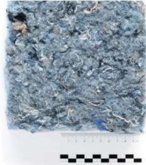
**Abb. 182** Denim-Dämmung- erhält während des Recyclingprozess schimmel- sowie pilz-abweisende Eigenschaften
