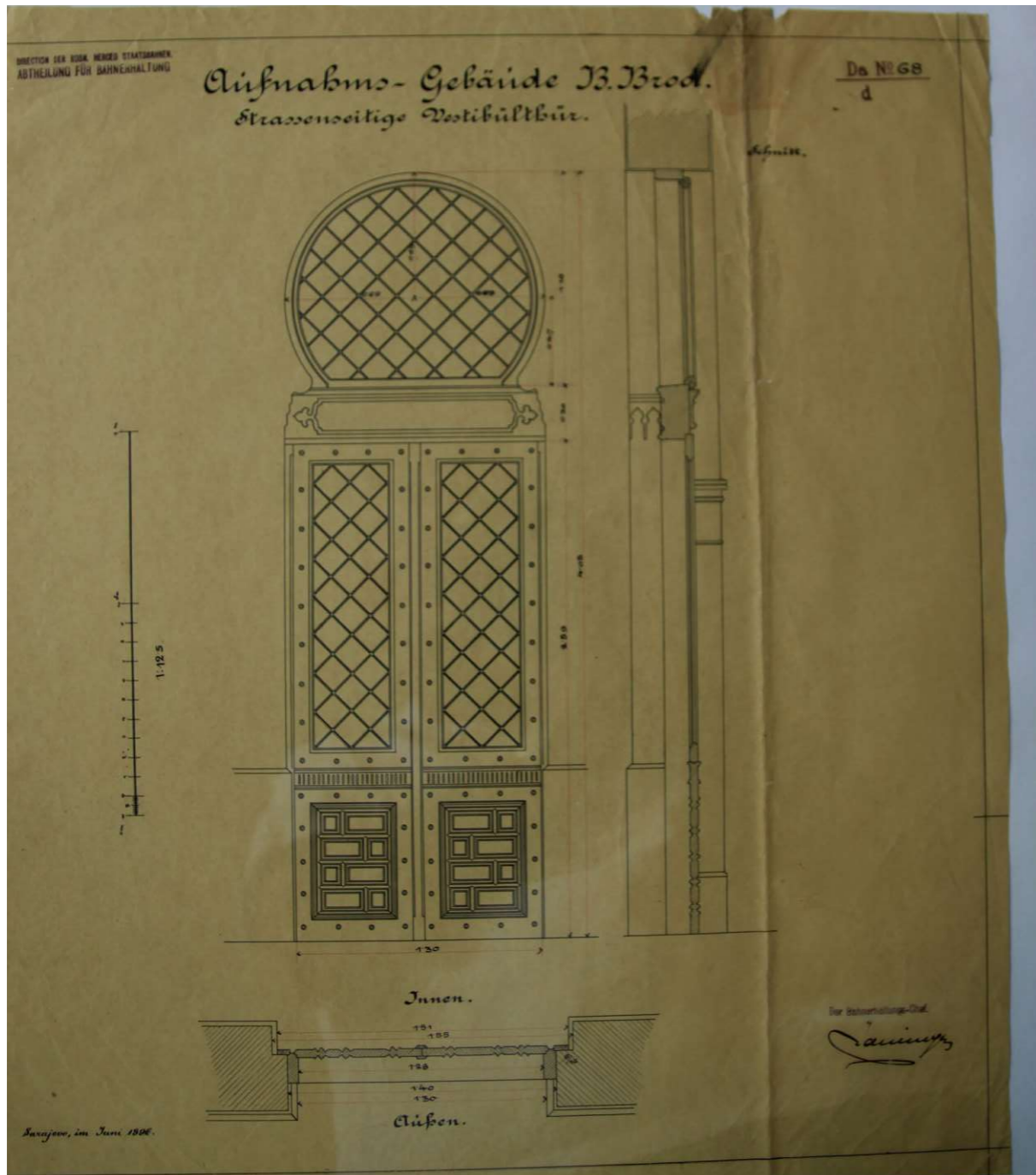
Anhang 14 - Ansichten und Schnitt der straßenseitigen Vestibültür, 1896
