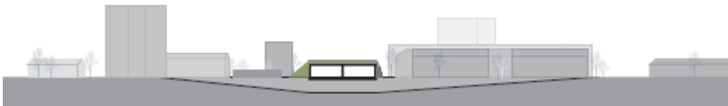
Abbildung 34 : Schnitt der geplanten Autobahneinhausung Schwamendingen [36]
