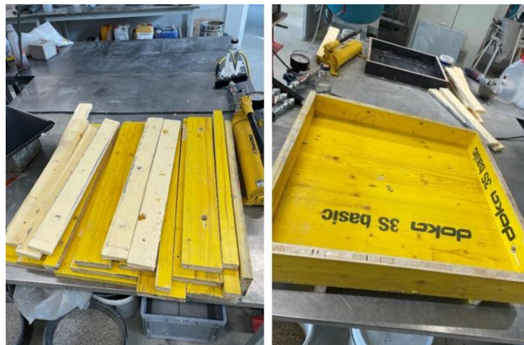
Abbildung 13 DOKA- Schalungselemente und fertige Schalung
