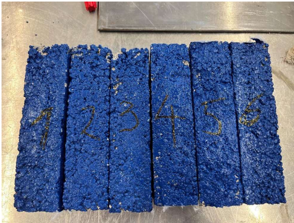
Abbildung 40 Beschichtete Prismen für den Saugversuch
