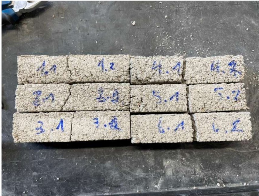
Abbildung 37 Prismen nach Biegezugfestigkeitsversuch
