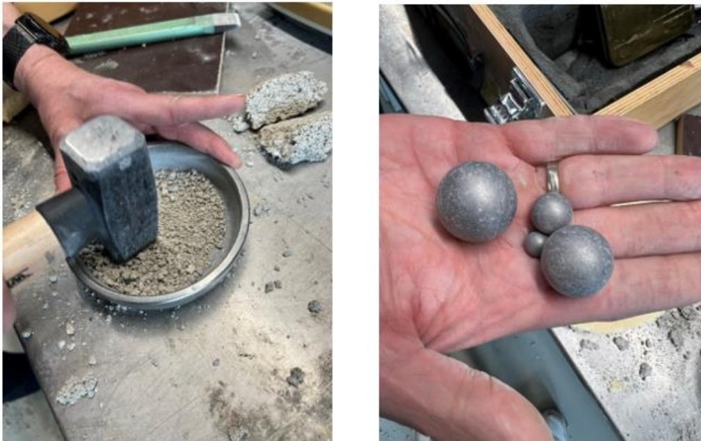
Abbildung 12 Zerkleinerung des Estrichs und Stahlkugeln
