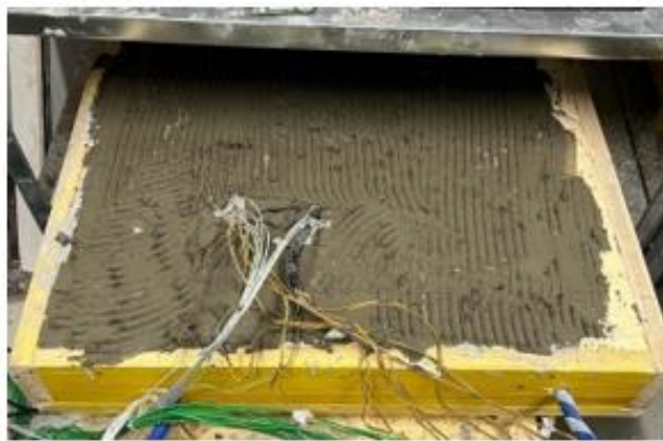
Abbildung 33 Estrichplatte mit vollflächiger Fliesenkleber und nach Verlegung der Fliesen
