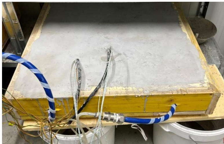
Abbildung 28 Estrichplatte mit aufgetragener Spachtelmasse
