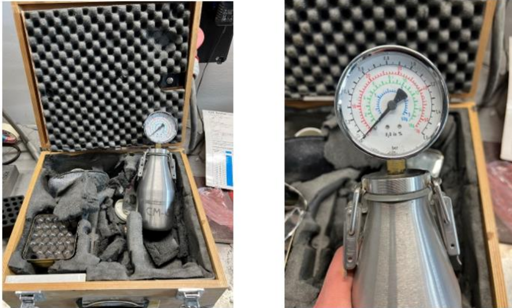
Abbildung 11 CM-Messgeräte und Manometer
