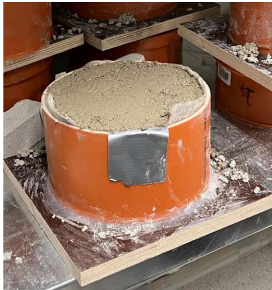
Abbildung 42 Probekörper für Durchführung CM-Methode
