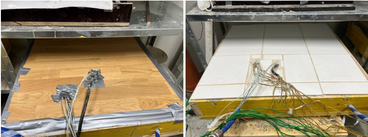
Abbildung 44 Estrichprobe 1 mit Parkettbelag links und Estrichprobe 2 mit Fliesenbelag rechts
