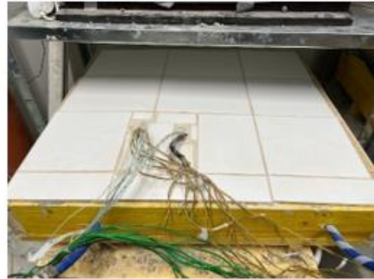
Abbildung 33 Estrichplatte mit vollflächiger Fliesenkleber und nach Verlegung der Fliesen
