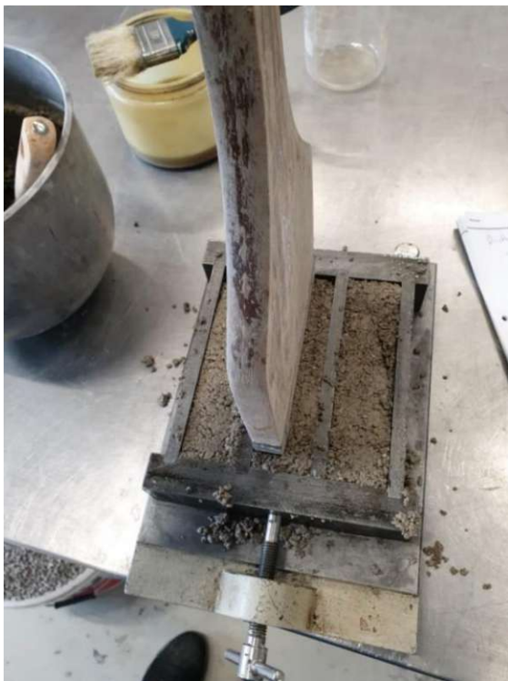
Abbildung 34 Rüttelverdichtung der Probekörper
