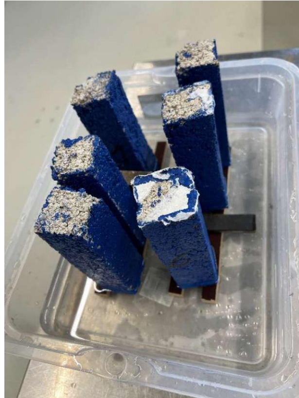
Abbildung 41 Prüfkörper in einem wassergefüllten Behälter
