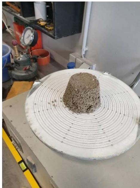
Abbildung 27 Versuch für Bestimmung des Ausbreitmaßes
