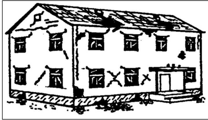
Abbildung 21: Schadensgrad 3 nach der EMS-98 [7].
