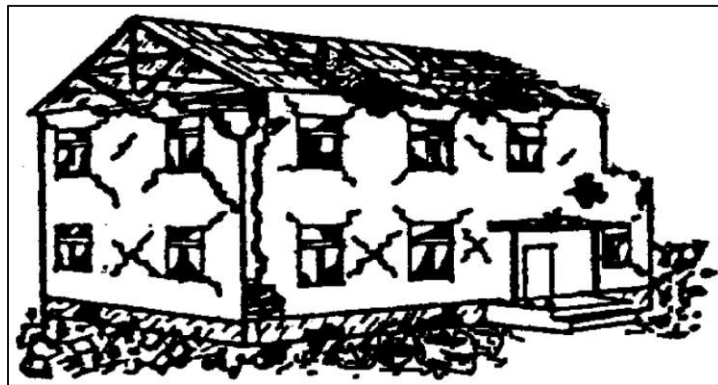
Abbildung 22: Schadensgrad 4 nach der EMS-98 [7].
