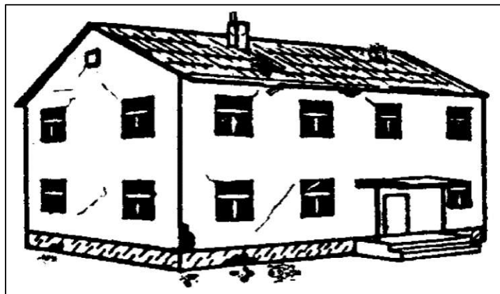
Abbildung 20: Schadensgrad 2 nach der EMS-98 [7].
