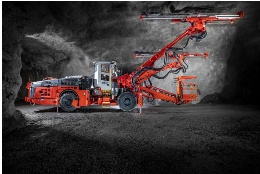
Abb. 2.3: Bohrwagen – Sandvik DT923i (Quelle: Bauforum 24 [5])
