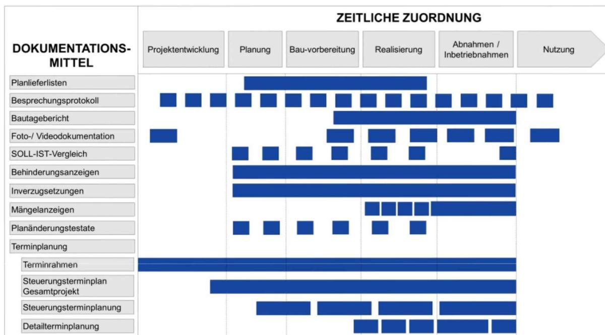
Abb. 2.12: Zeitliche Darstellung aller Dokumentationsmitteln in den unterschiedlichen Projektphasen (Quelle: Kochendörfer et al. [22, S. 149])
