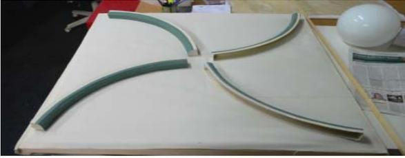
Die Lüftungsklappen werden zunächst ohne hydraulische Mechanik eingebaut. Sie müssen in diesem ersten Prototypen per Hand bedient werden. Luftdurchlässigkeit und Luftströmung in der Hinterlüftung kann für die so entworfene Konstruktion abgeschätzt werden.
