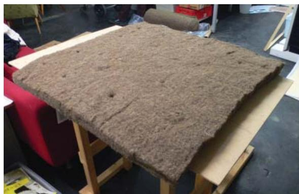
Das vorbereitete Kühlpad wird aufgelegt, das Foto zeigt die spätere Innenansicht der Fassade ohne Stoffhülle. Die Kühlpads entsprechen im Aufbau Abb.77
