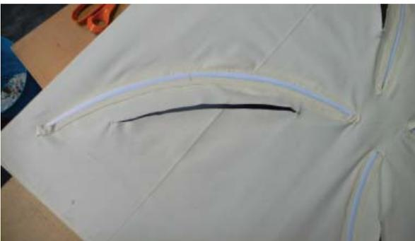
Die Lüftungsklappen werden danach in das Element eingesetzt und mit dem Stoff vernäht bzw. verklebt.
