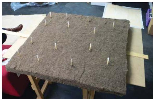
Die Dämmschicht wird mit Stoff überzogen.
