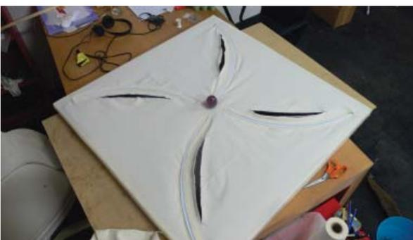
Die Abbildung zeigt die fast fertige äußere Dämmschicht mit den eingebauten Lüftungsklappen.
