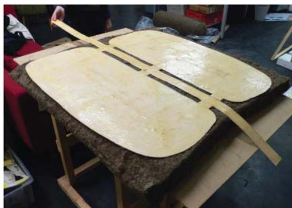
Umgedrehte innere Dämmschicht - die Verbindungsadern zwischen Kühlpads und Verdunstungsschicht sind hier sichtbar.
