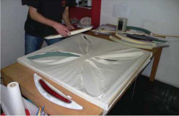
Zunächst wird der Hüllstoff an den richtigen Stellen eingeschlitzt
