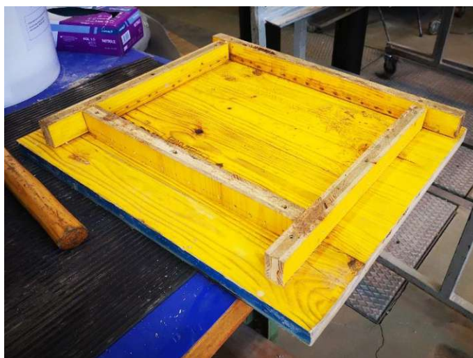
Abbildung 37: Erster Prototyp der Schalung (Deckel nicht abgebildet)
