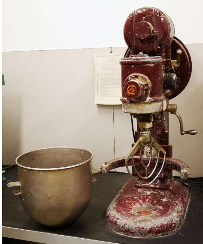
Abbildung 42: Mischer zur Herstellung des Mörtels
