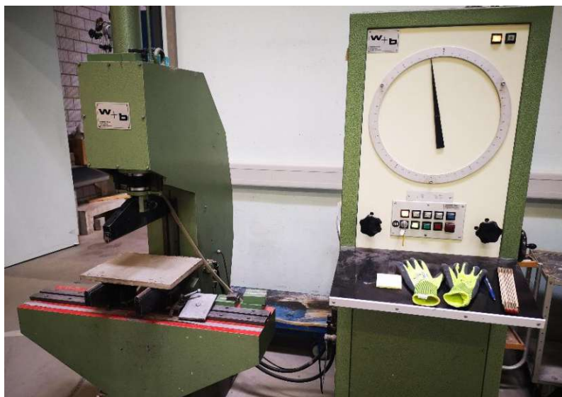
Abbildung 45: Biegezugversuch an der Presse Walter+Bai PK-NS 19
