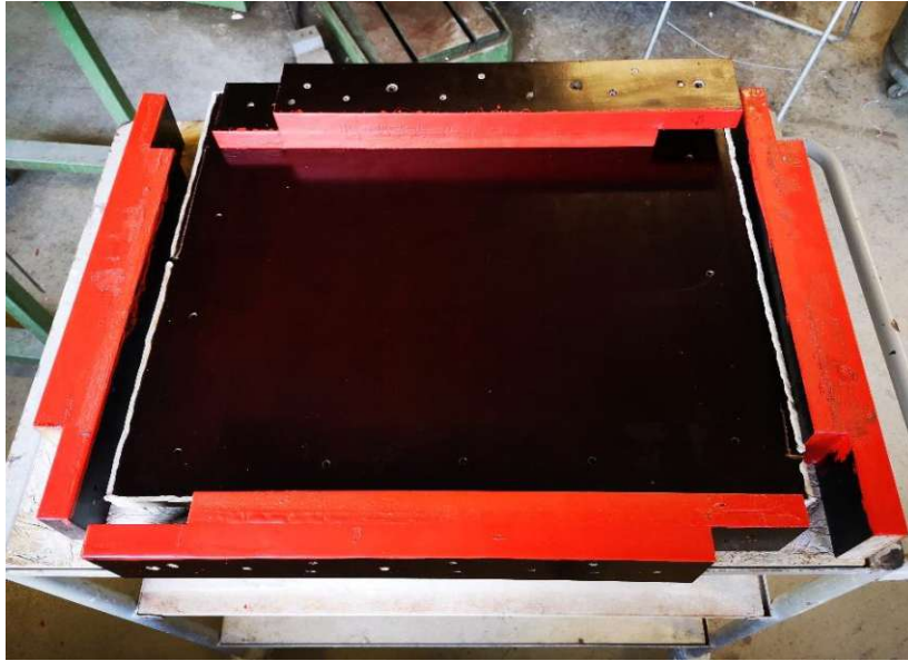
Abbildung 41: Fertige Schalung mit demontierten Seitenteilen
