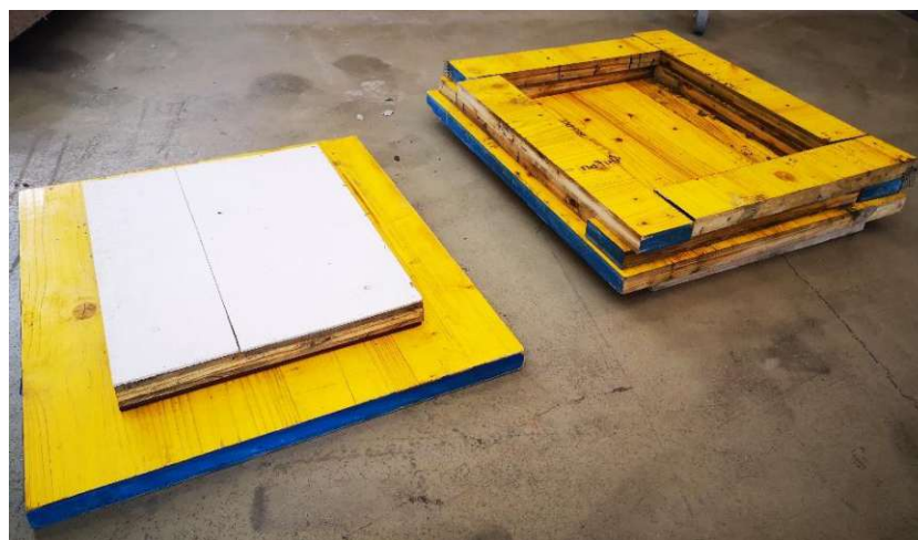
Abbildung 38: Zweiter Prototyp der Schalung
