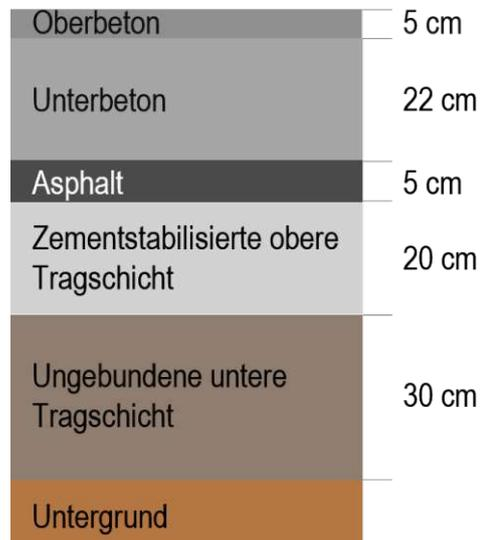
Abb. 4.10: Schichtaufbau der FMS A10
