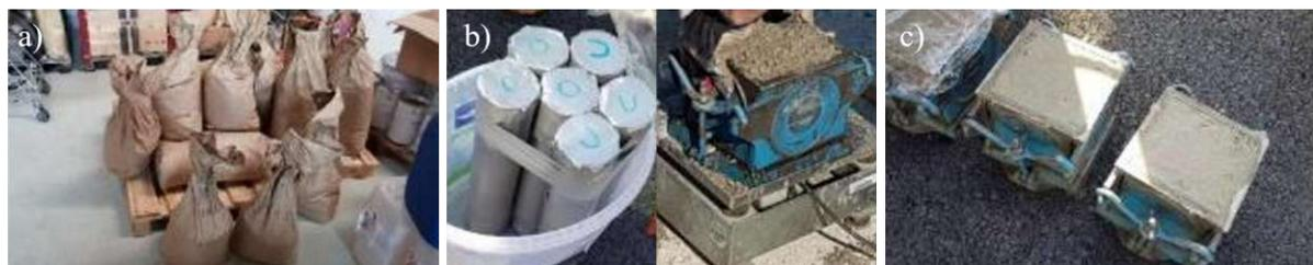
Abb. 2.14: Entnahme von Probekörpern, a. Asphaltproben von jeder Schicht, b. & c. anfertigen von Betonzylindern und -würfeln
