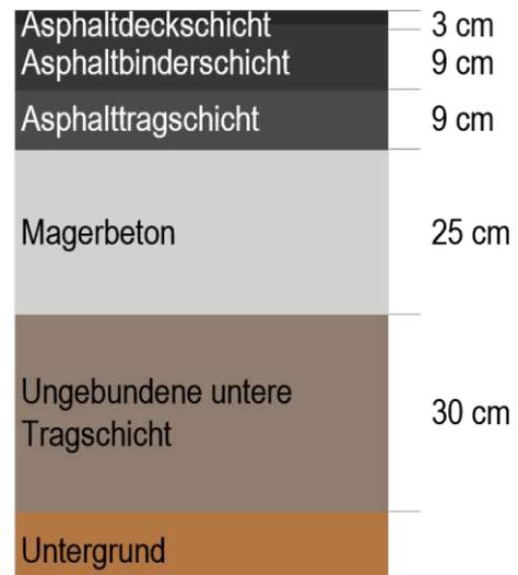
**Abb. 4.42:** Schichtaufbau an der FMS A3
