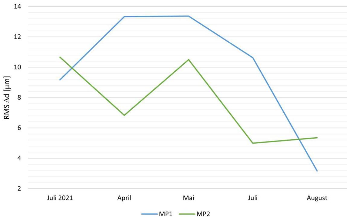
Abb. 4.55: Quadratisches Mittel (Root Mean Square, RMS) der Abweichungen der Berechnungsergebnisse pro Messung
