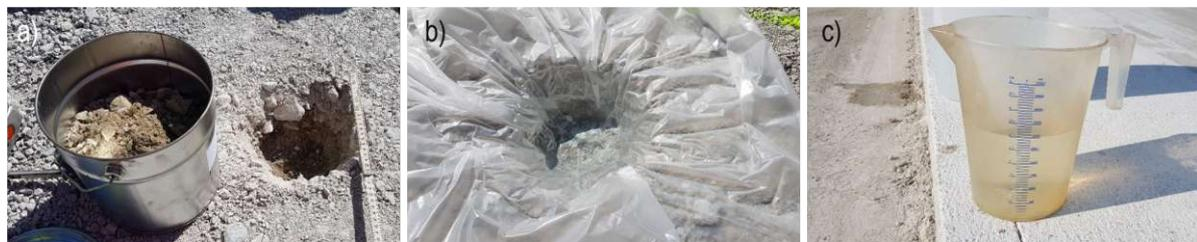
Abb. 2.13: Bestimmung der Massendichte, a. Entnahme von Material, b. Auslegen mit robuster Folie, c. Befüllen des Loches mit Wasser und abmessen des benötigten Volumens
