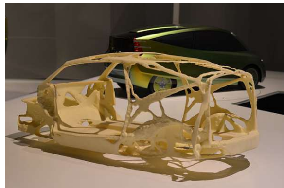
(b) Rohbaustruktur in Leichtbauweise
