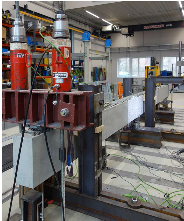
Abbildung B.2: Versuchsaufbau QB. Vorderer Trägerbereich: Lastbringende Pressen. Mittlerer Trägerbereich: ARAMIS-Messfeld und vorderes Auflager. Hinterer Trägerbereich: hinteres Auflager.
