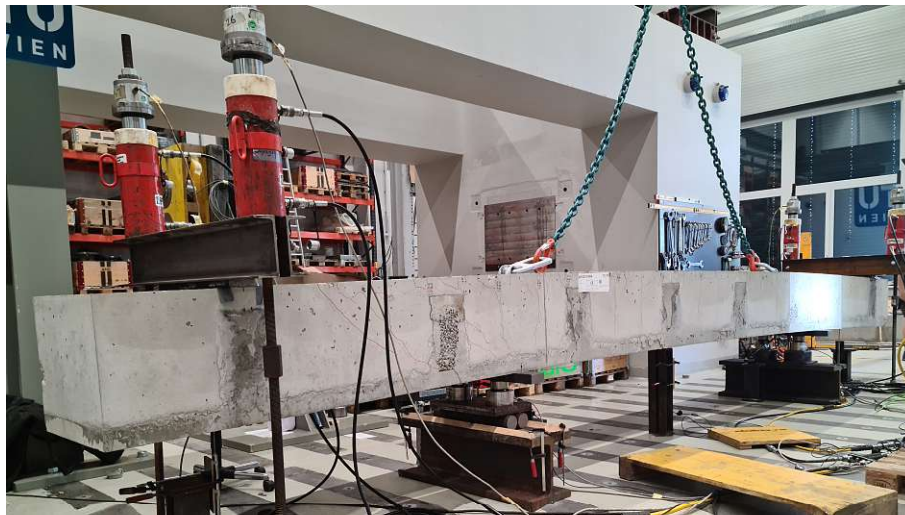
Abbildung B.7: Versuchsdurchführung Längsbalken am Beispiel des Versuchskörpers N im Moment der maximalen aufgetragenen Last.
