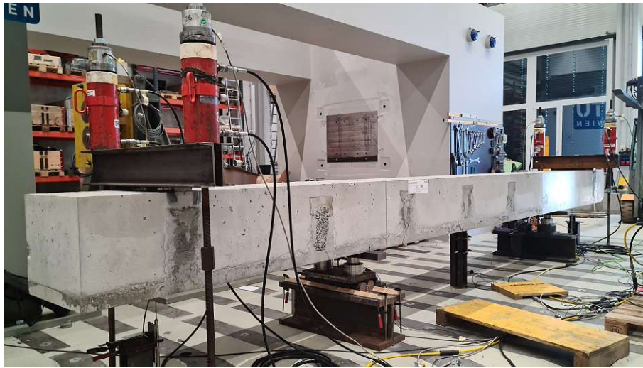
Abbildung B.6: Versuchsaufbau Längsbalken. Lastbringende Pressen im vorderen und hinteren Trägerbereich. ARAMIS Messfeld über dem hinteren Auflager.
