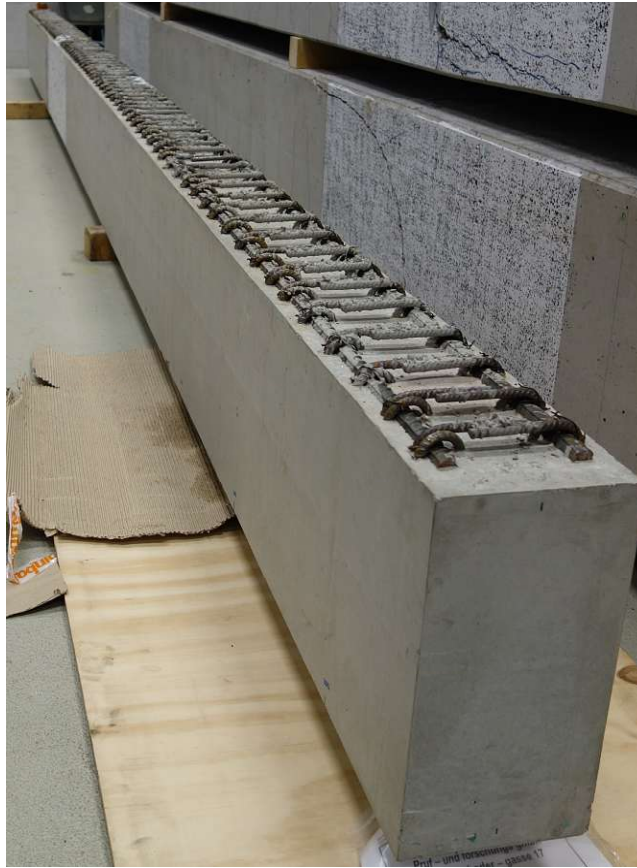
Abbildung B.1: Versuchskörper QB mit herausragender oberer Biegebewehrung, oben offenen Schubbügeln und Schlaufen zur Verankerung der Biegebewehrung.
