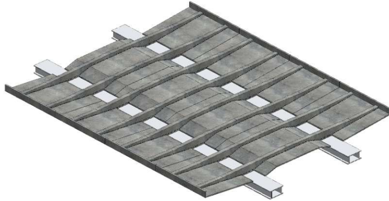
Abbildung 4.11: Halbfertigteile Typ Z versetzt auf Hilfskonstruktion. Bildquelle: [32]
