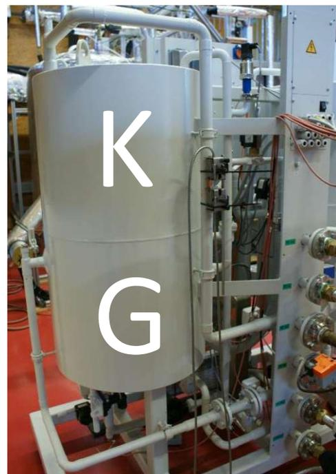
Abbildung 20: links: Absorptionswärmepumpe frontal mit Bedienungspanel; rechts: Rückseite des Generators/Kondensator-Behälters, sowie Blick auf die sechs hydraulischen Ein- und Ausgänge
