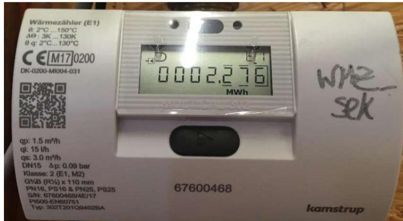
Abbildung 30: Wärmemengenzähler MULTICAL 302
