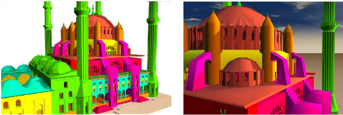
Abb.181-182 Die Tragelemente der Selimiye-Moschee
