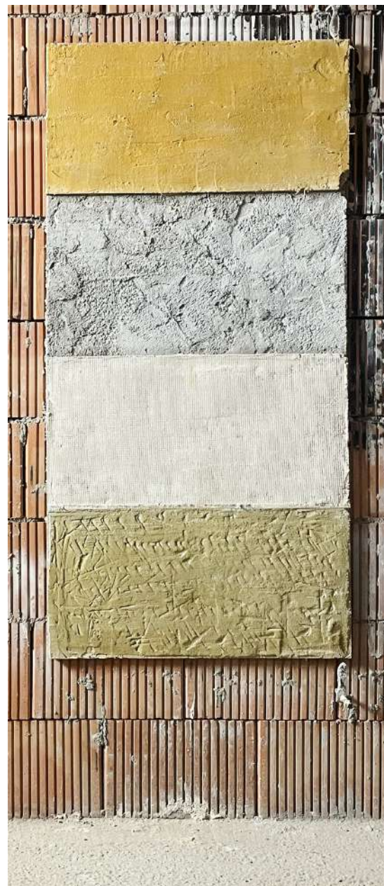
Die fertigen Putztafeln nach einer Trocknungszeit von zwei Woche Sep.2022 / Olympus Mju ii
