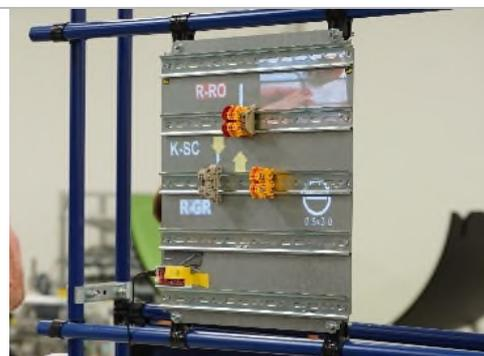
**Abbildung 30: Projektionssystem „Arbeitsanweisung Elektroschaltschrank“ © Johann Li**
