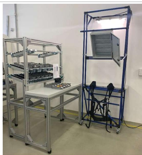
Abbildung 28: Arbeitsplatz Schaltschrankmontage in der TU Wien Pilotfabrik, eigene Darstellung
