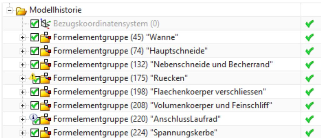
Abbildung 3.2: Siemens NX Modellhistorie mit Geometriebefehlen in Formelementgruppen
