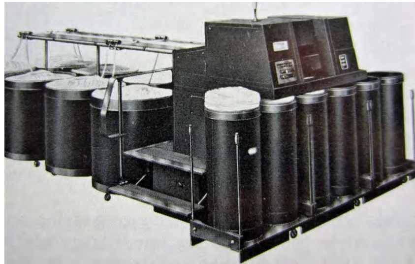
Abbildung 30: Streckmaschine mit einer Ablieferungskanne
