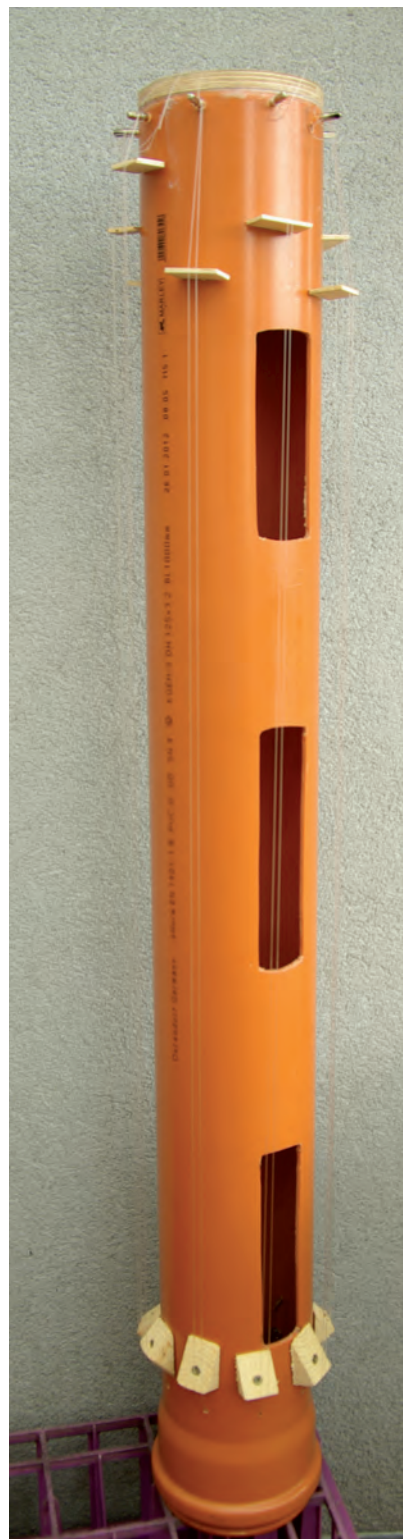
Abb. 5.7: Abschnitte der Entwicklung von YOUR AIOLOS, hier der erste Prototyp mit verschiedenen Saiten, Stegen, Stimmwirbelhölzern; Quelle: Autor
