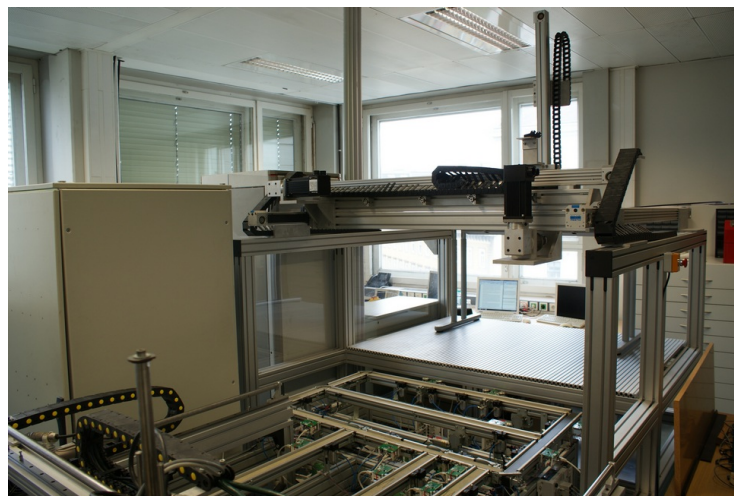
Abbildung 1.1.: Verteiltes Palettentransportsystem im Odo Struger Labor der TU Wien
