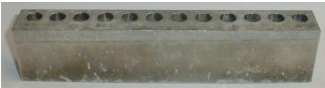
Abbildung 3.3: Aluminiumständer für das Sedimentieren
