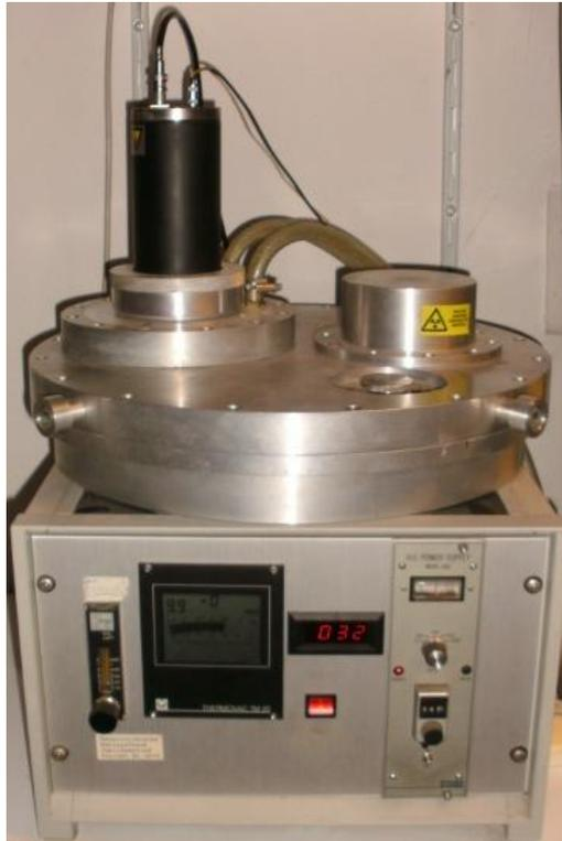
Abbildung 3.6: Ansicht der Thermolumineszenzanlage "HVK"
