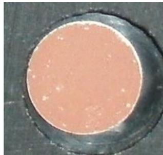
Abbildung 2.11: Mit Probenstaub belegtes Plättchen mit 10 mm Durchmesser
