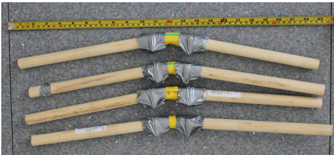
Abbildung 19: Verstärkung des Kniegelenks
