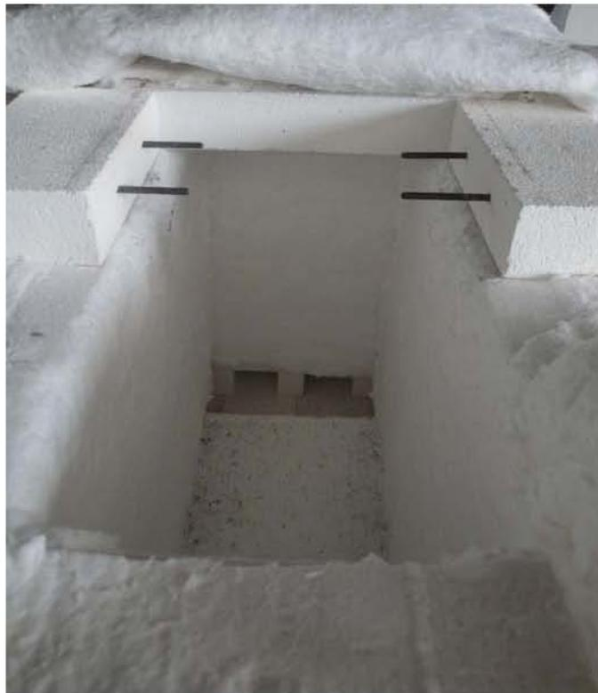
**Abbildung 4-26:** Innenraum des gedämmten Brandofens
