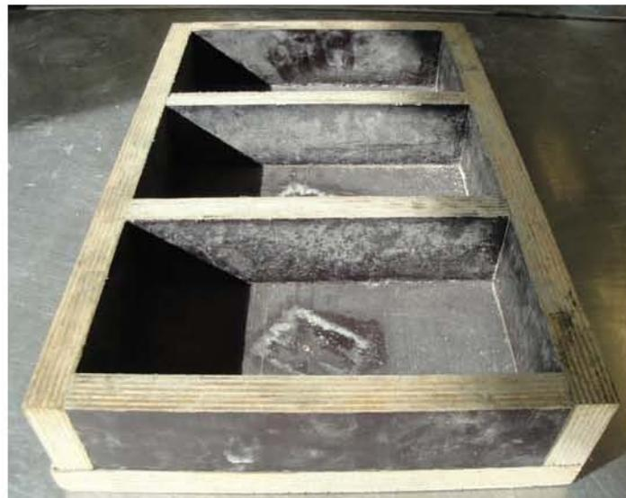
**Abbildung 4-1:** Schalung für drei Probekörper
