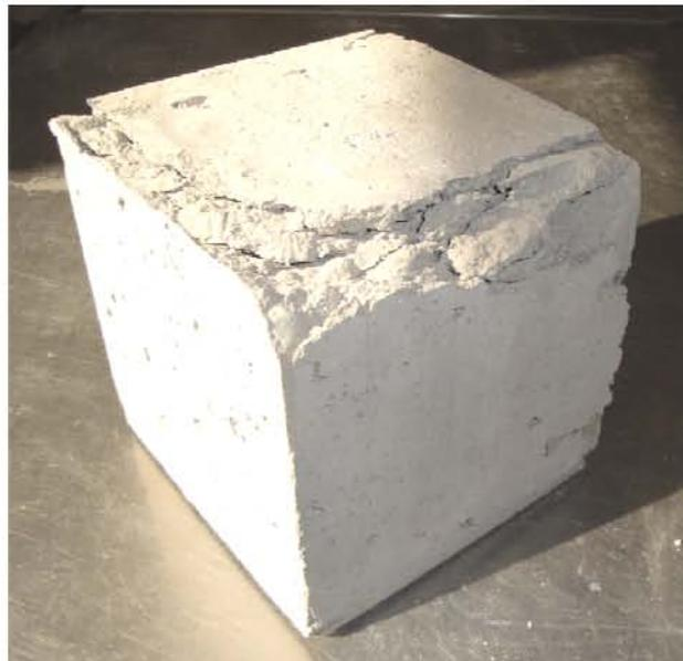
**Abbildung 4-3:** Betonwürfel nach der Druckprüfung
