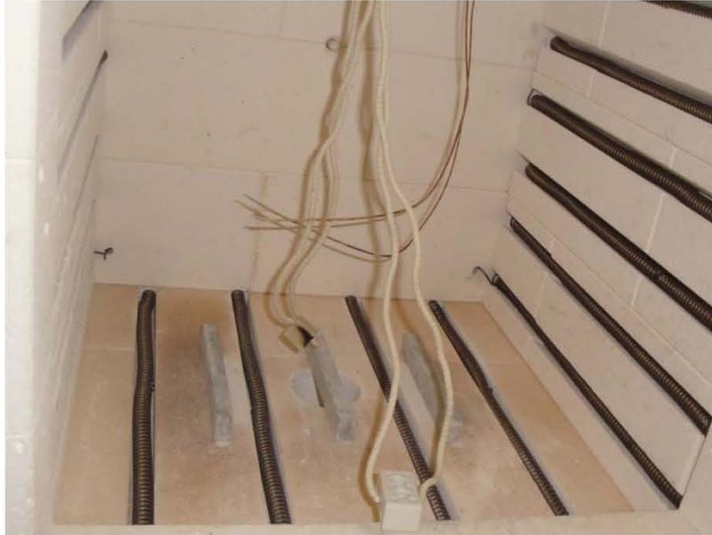
**Abbildung 4-8:** Im Inneren des *KITTEC Classic Line* Brennofens
