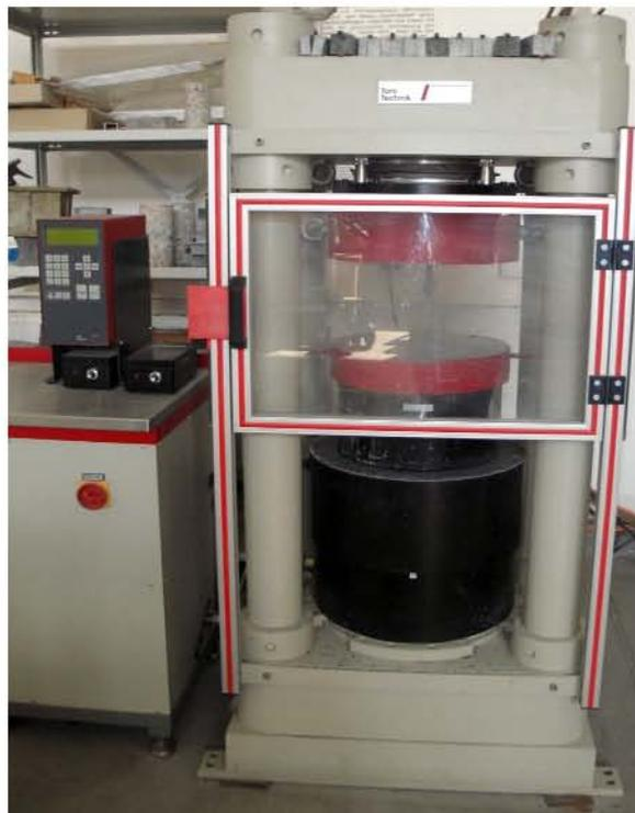
**Abbildung 3-6:** Prüfmaschine *TONI TECHNIK*
