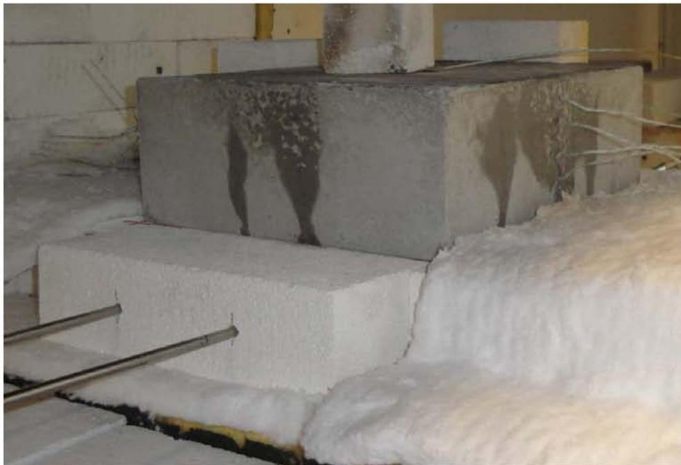
**Abbildung 4-34:** Brandversuch an einem feuchten Probekörper
