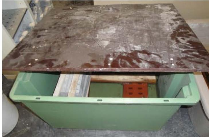
**Abbildung 4-6:** Lagerung der feuchten Probekörper
