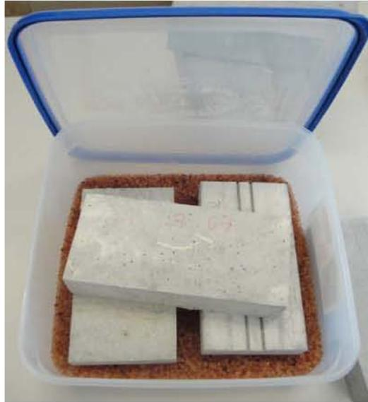
**Abbildung 4-5:** Probekörper im Exsikkator
