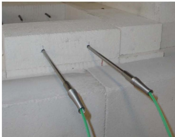
**Abbildung 4-22:** Anordnung der Thermoelementfühler
