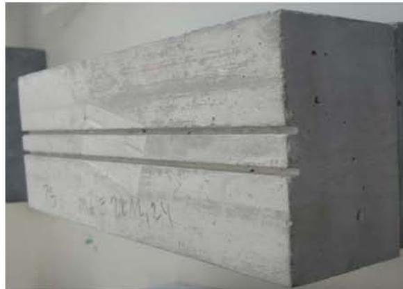
**Abbildung 4-4:** Probekörper für die Heißdrahtprüfung mit Einkerbungen
