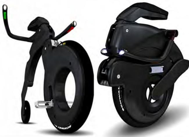
Abb. 050 Elektro-Klapprad „YikeBike“, Portable
