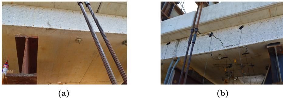
**Abb. 3.27:** Versagensbilder für den Versuchskörper SL2: (a) Fließen der Längsbewehrung gekennzeichnet durch eine überproportionale Öffnung des Biegerisses bei Versuch SLzo-t, (b) Schubriss an der Rückseite von Versuchskörper SLo-t
