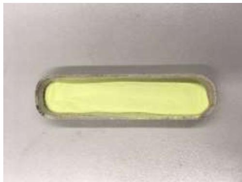
Abbildung 18: Schiffchen befüllt mit  $WO_3$
