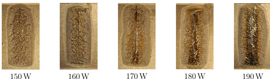
Abbildung 10.40: Grafische Darstellung der Verbindungsnahte für das gesamte Leistungsspektrum des Verbindungsprozesses-Teil 2: Leistungsbereich 150 W-190 W - Glasperlengranulat mit R_a=1,48\ \mu\text{m}
