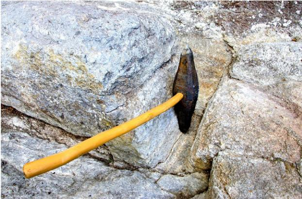
Abb. 6: Nachgeschmiedeter Doppelspitzschlägel in originalem Schrägraben
