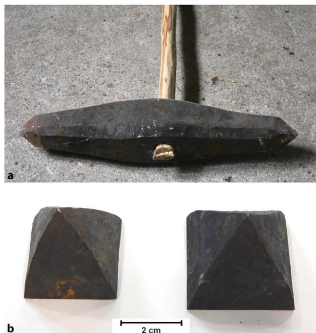
Abb. 2: Nachgeschmiedeter Doppelspitzschlägel. a Gesamter Schlägel mit angebrachtem Holzstiel (aus Eibe) für Versuche im Marmorsteinbruch, b zwei nachgeschmiedete und gehärtete Spitzen für werkstoffkundliche Untersuchungen
