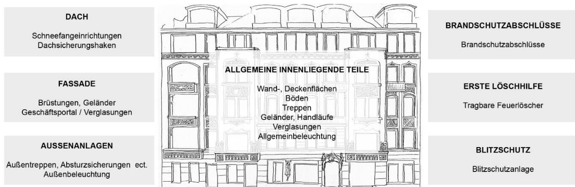
Abbildung 11: Übersicht der am häufigsten gebotenen Nachrüstungen. Quelle: Eigene Darstellung nach Junker, 2018, S.49.
