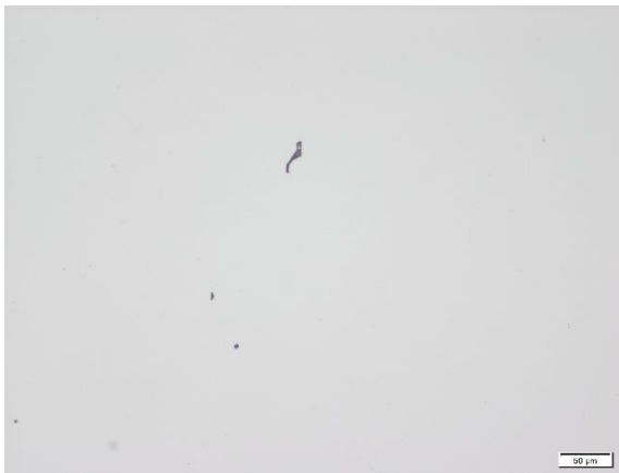
Abbildung 107: LOM: A6 HEA-Ingot, ungeätzt,
