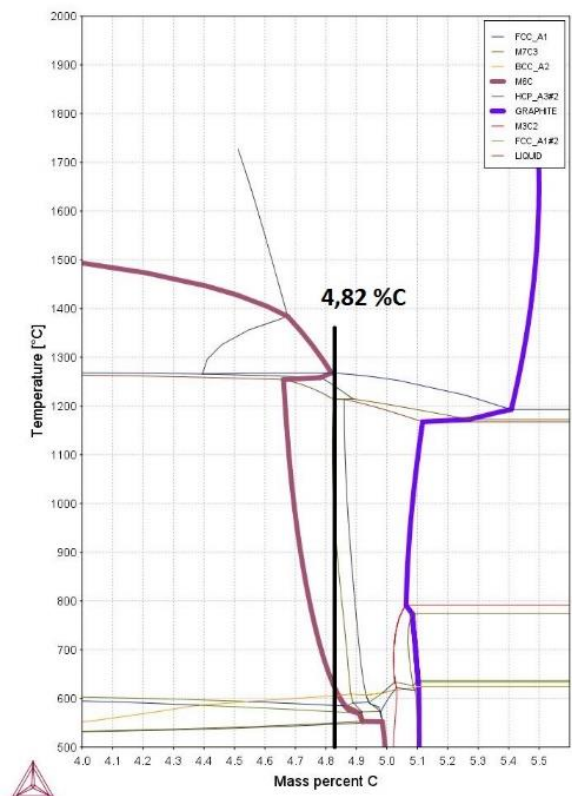
Abbildung 240: Phasendiagramm von WC/CoFeNi-2 Cr
