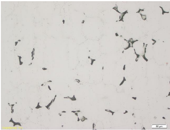
Abbildung 153: LOM: A8 HEA-Ingots, ungeätzt
