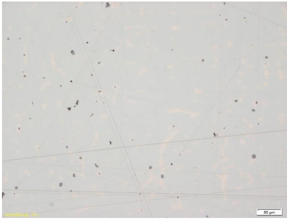
Abbildung 212: HEA-Ingot A10, ungeätzt
