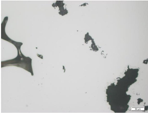
Abbildung 12: LOM Aufnahme des ungeätzten HEA-Ingots Al
