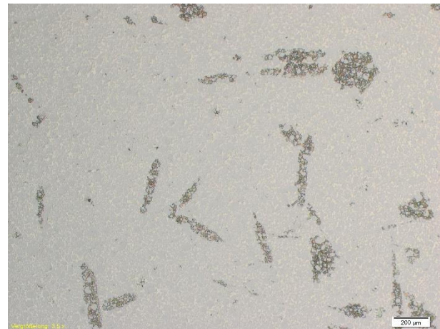
Abbildung 18: Infiltriertes Hartmetall WC/Al, Murakami 5s
