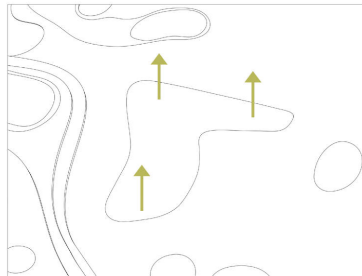
Schritt 4 Die entstandene Form wird nach oben gezogen und bildet ein Volumen
