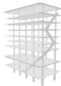
Zur Beförderung sogenannter Binkelposten stand eine massive geschlossene Pfänderrutsche aus Stahlbeton zur Verfügung, welche im Zickzack durch alle Geschosse verläuft. Im 1. Obergeschoß wird sie über einen Bogen entlang der Fassade bis ins Erdgeschoß geführt.
