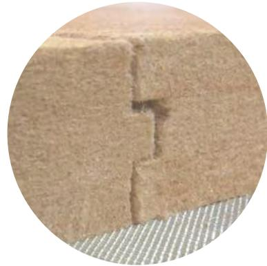
Abb. 194: Weichfaserdämmplatte aus Holz
