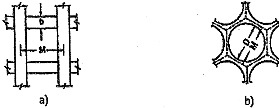
Abbildung 3-5: a) quadratische Öffnungsform von Strömungsgittern, b) Öffnungsform von perforierten Platten.
