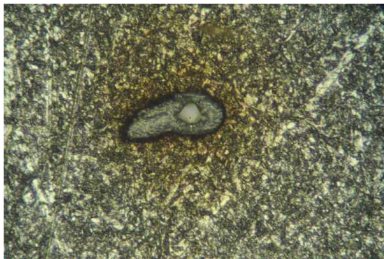
Abbildung 5.17: Beispiel eines Einschusslochs bei einer Brennweite von 100 mm
