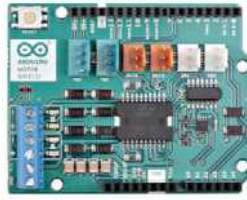
Abbildung 3.15: Arduino Motor Shield Rev3 [22]
