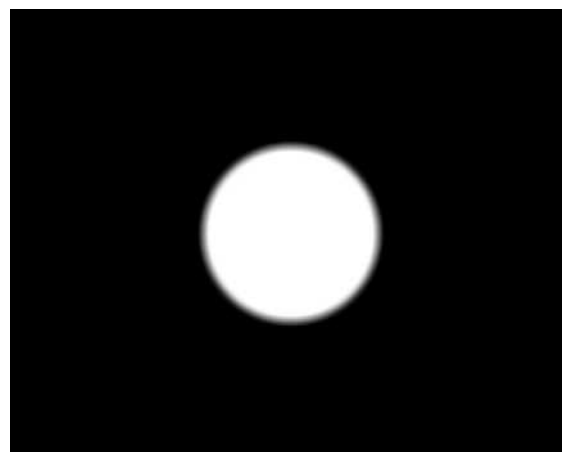
(b) Bild nach Verschmierung mit einer 25 \times 25 Kernelmatrix
