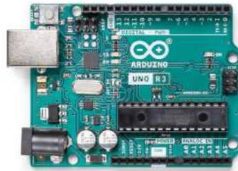
Abbildung 3.14: Arduino UNO Rev3 [20]
