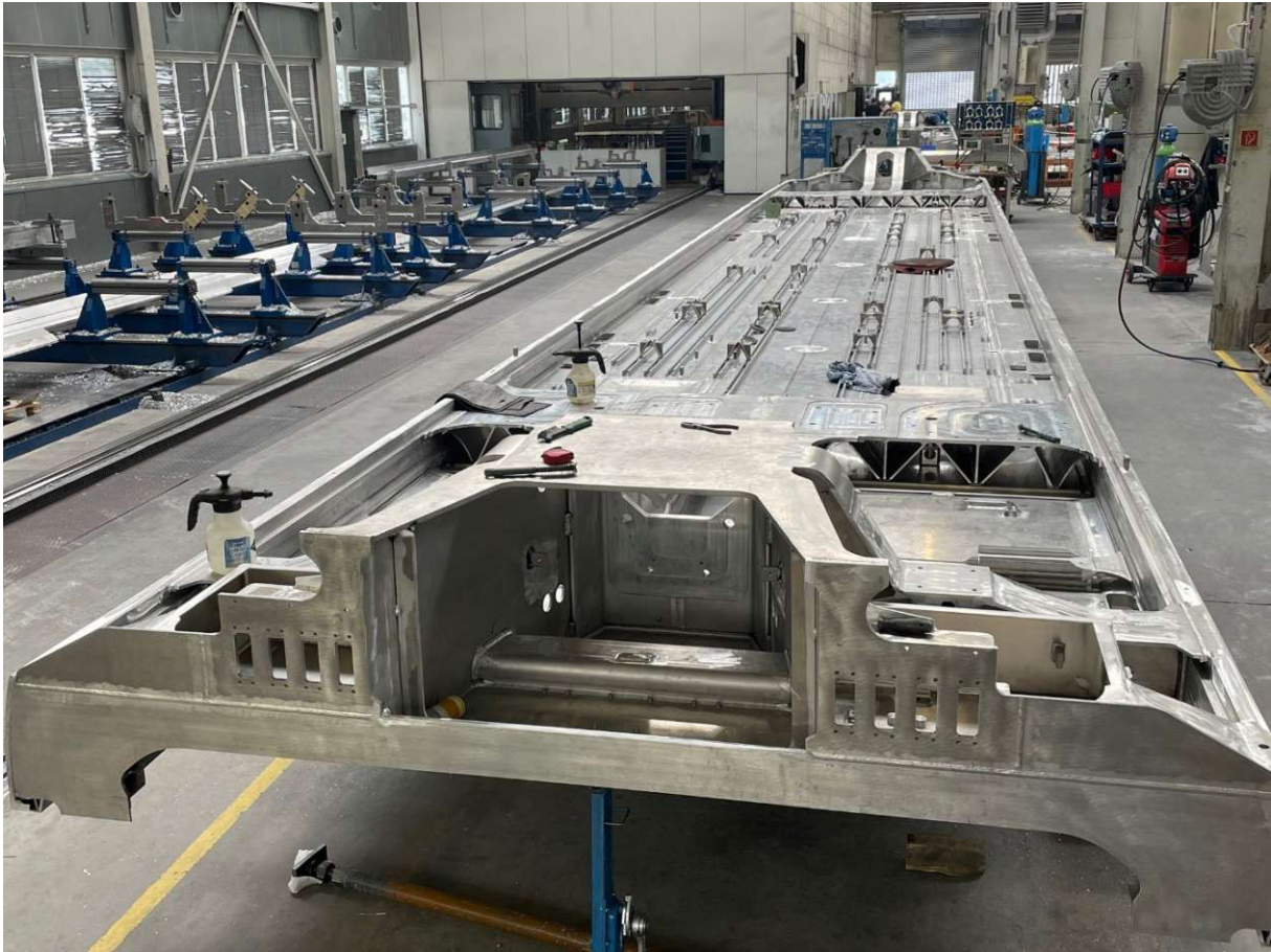
Abbildung 12: Untergestell (Werksfoto: Siemens Mobility Austria GmbH)
