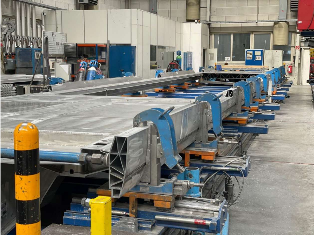
Abbildung 46: Vorrichtung für das Einspannen der Untergestell Langträger (Werksfoto: Siemens Mobility Austria GmbH)
