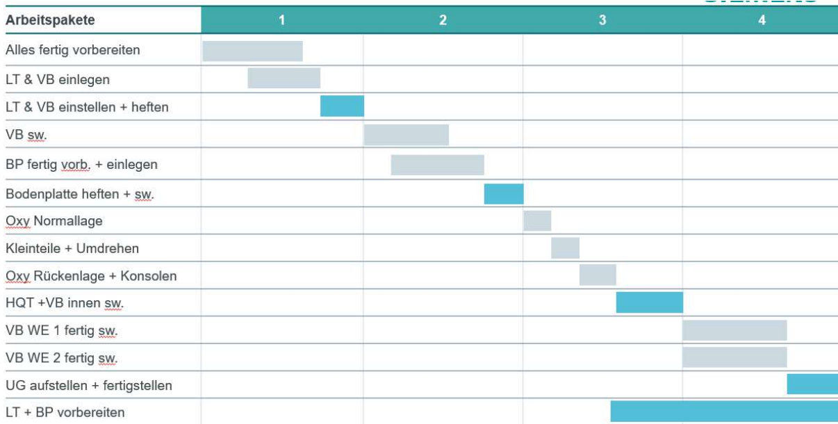
Abbildung 69: Darstellung des Soll-Arbeitsplans für die Fertigungslinie der Untergestelle, Station 1, Variante 2 (eigene Darstellung)
