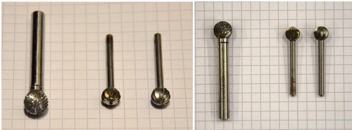
Abbildung 5-4: Vergleich des benutzten Fräskopfes mit 10 mm Durchmesser (jeweils links) mit dem benutzten 7,8 mm-Fräskopf (jeweils in der Mitte) und einem neuen 7,8 mm Fräskopfs(jeweils rechts)
