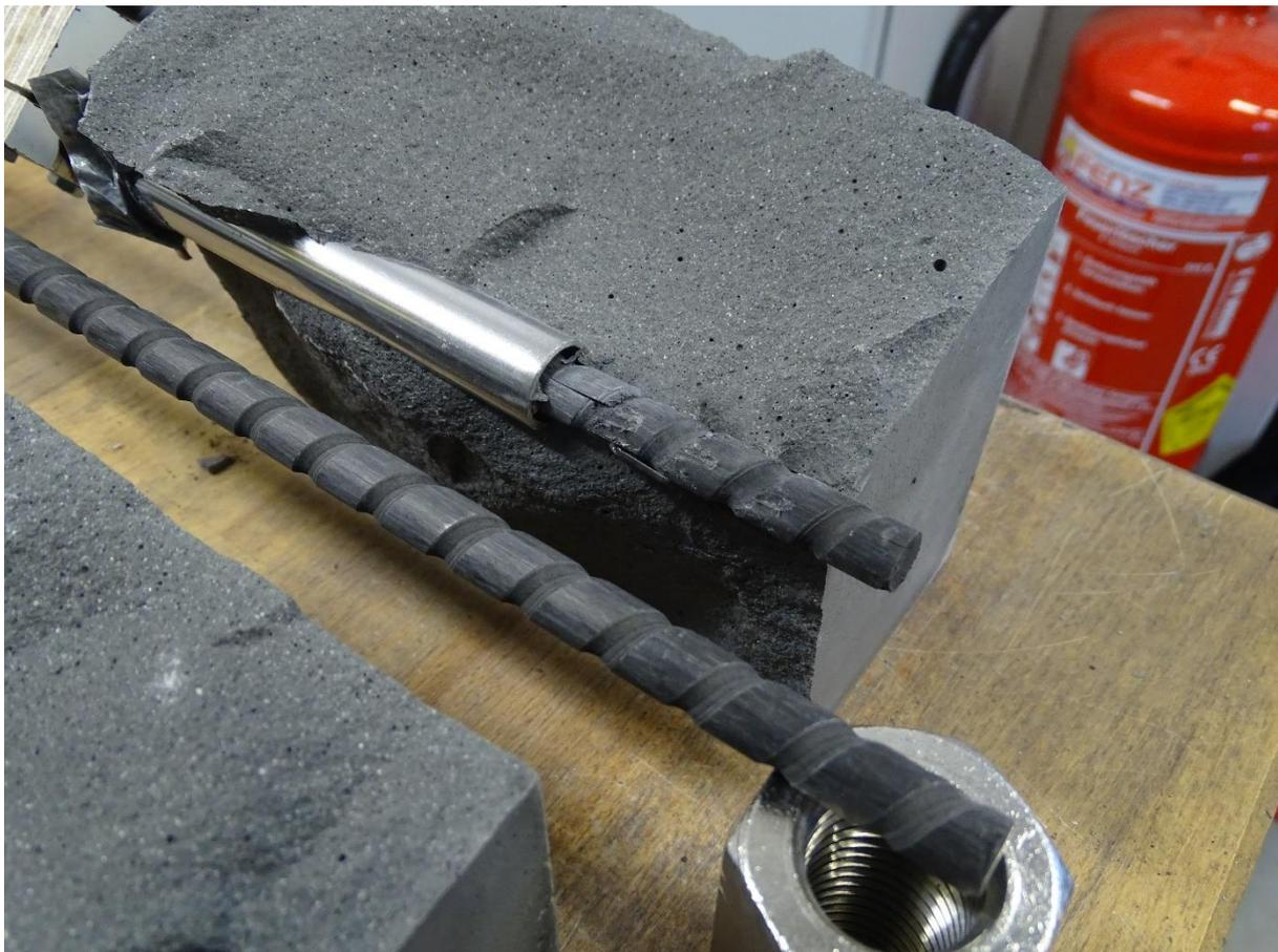
**Abbildung 5-55: Abgeschnittene erste Rippe des Stabs in Prüfkörper 23 mit unbeschädigtem Stab zum Vergleich**
