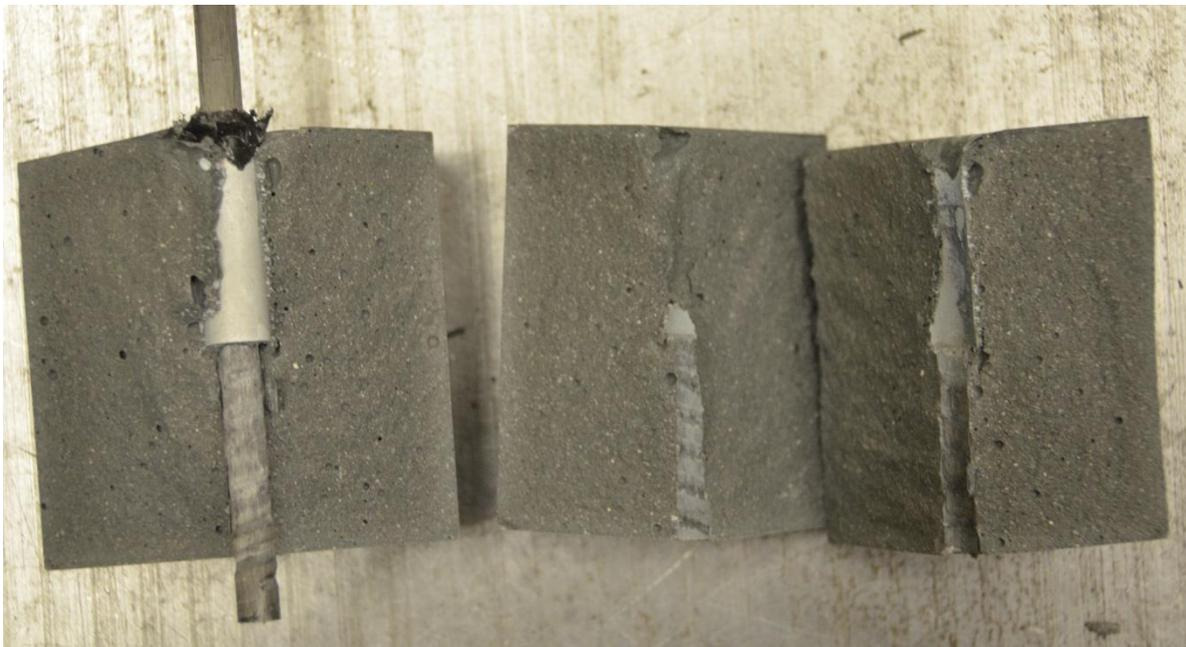
Abbildung 5-20: Vollständig abgescherte Stabrippen in Prüfkörper 14
