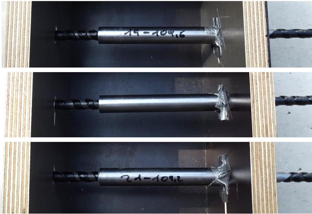
Abbildung 5-51: Vergleich der Rippen in der Verbundlänge der Stäbe 19 (oben), 20 (Mitte) und 21 (unten)
