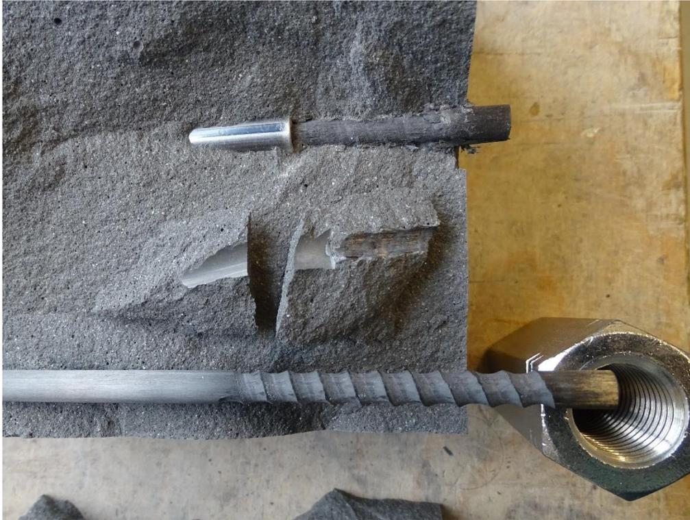
Abbildung 5-48: Abgescherte Wendel des Stabs in Prüfkörper 14 mit einem unbeschädigten Stab zum Vergleich
