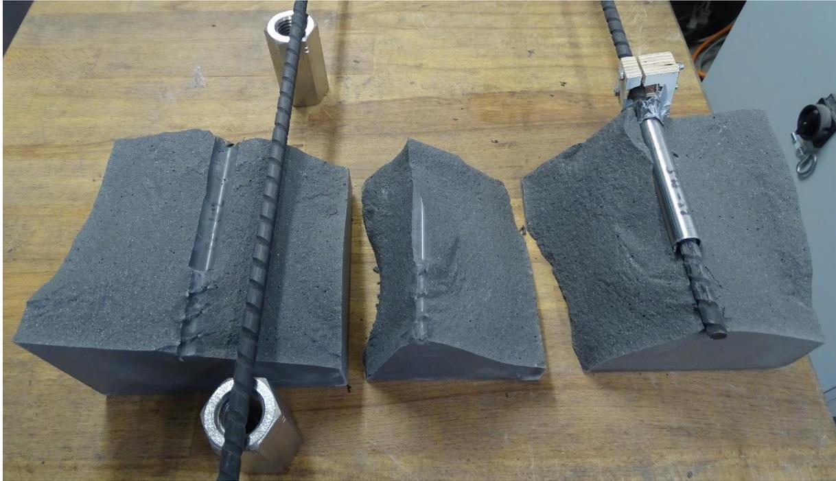
**Abbildung 5-54: Nahezu unbeschädigter Stab und intakte Betonkonsolen im Inneren des beim Versuch gespaltenen Prüfkörpers 22**
