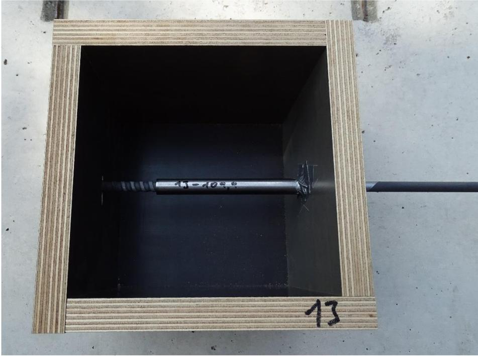
**Abbildung 5-33: Schalung mit eingebautem Stab für die zweite Versuchsreihe**
