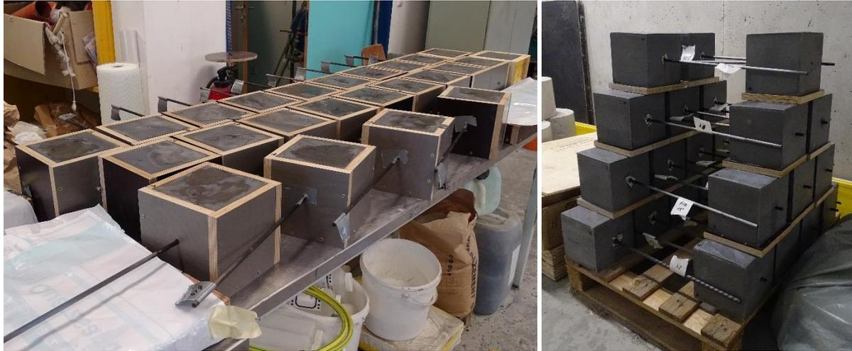
Abbildung 5-34: Prüfkörper 24 Stunden nach dem Betonieren (links) und nach dem Ausschalen (rechts)
