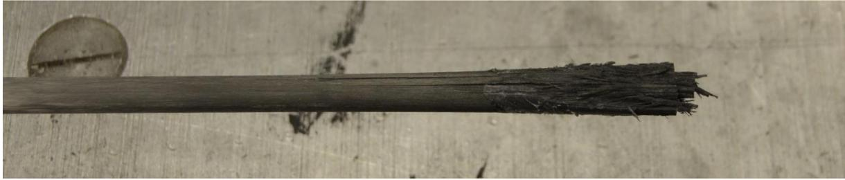
**Abbildung 5-11: Zerdrücktes Zugende des CFK-Stabs in Versuchskörper 6**
