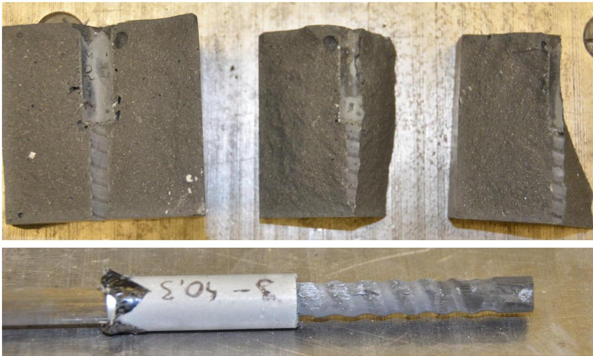
**Abbildung 5-12: Gespalteener Prüfkörper 3 (oben) und beschädigter Stab 3 (unten) nach dem Versuch**
