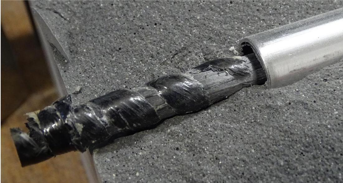
Abbildung 5-50: Abgelöste und am oberen Ende der Verbundlänge abgerissene Rippe am Stab in Prüfkörper 21
