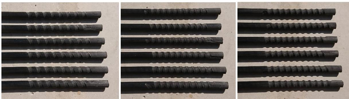
**Abbildung 5-32: Gefräste Stäbe mit einer Wendelsteigung von 20° und dem Fräskopf mit 6,0 mm Durchmesser gefräst (links), einer Wendelsteigung von 15° und dem Fräskopf mit 6,0 mm Durchmesser gefräst (Mitte) und einer Wendelsteigung von 15° und dem Fräskopf mit 10 mm Durchmesser gefräst (rechts)**
