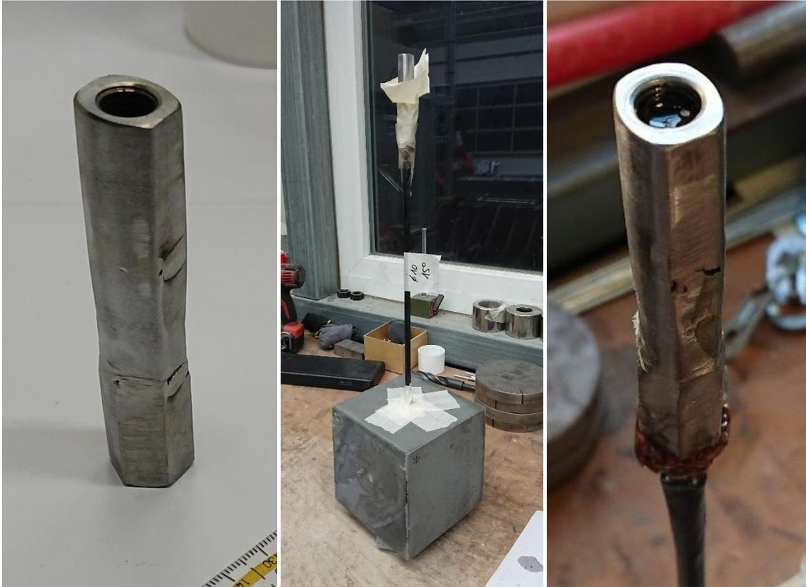
**Abbildung 5-38: Aus zusammengeschweißten Langmuttern hergestellte Muffe, vor und nach dem Befüllen mit Epoxidharz und im ausgehärteten Zustand**
