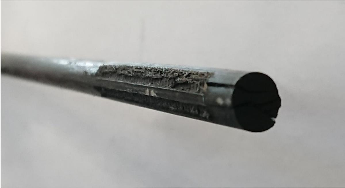
**Abbildung 5-36: Zerdrücktes, gespaltenes Stabende nach dem ersten Versuch mit Prüfkörper 4, bei dem das Stabende direkt in die Klemmbanken gespannt wurde**
