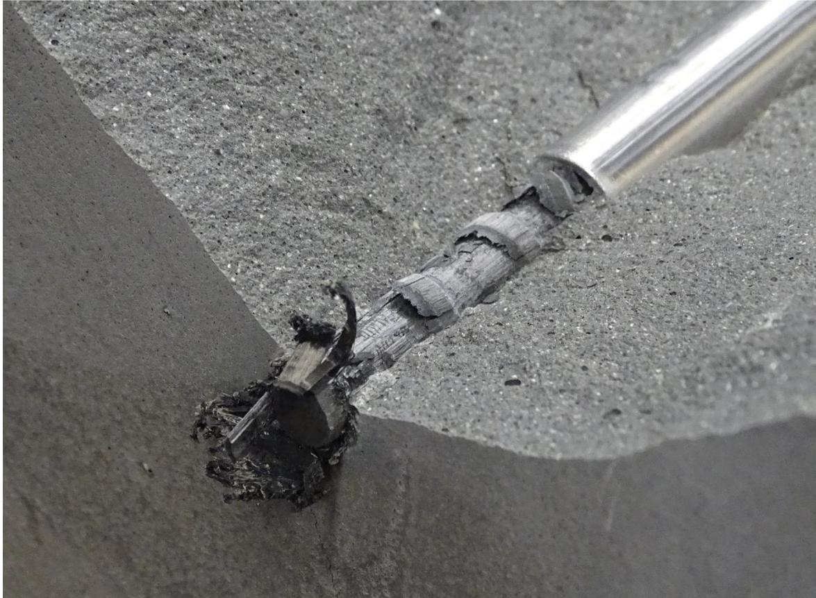
**Abbildung 5-46: Abgescherter Stabwendel bei Prüfkörper 12**
