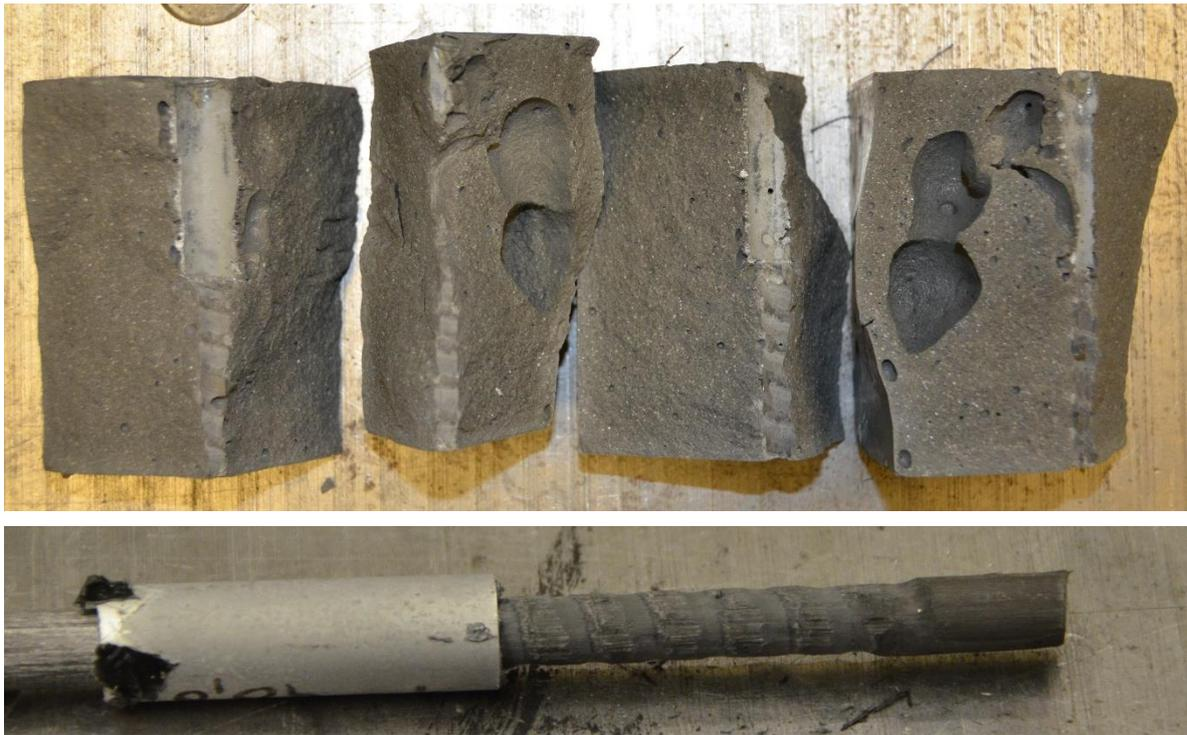
Abbildung 5-13: Gespaltener Prüfkörper 4 mit großen Gasblasen (oben) und beschädigter Stab 4 (unten) nach dem Versuch
