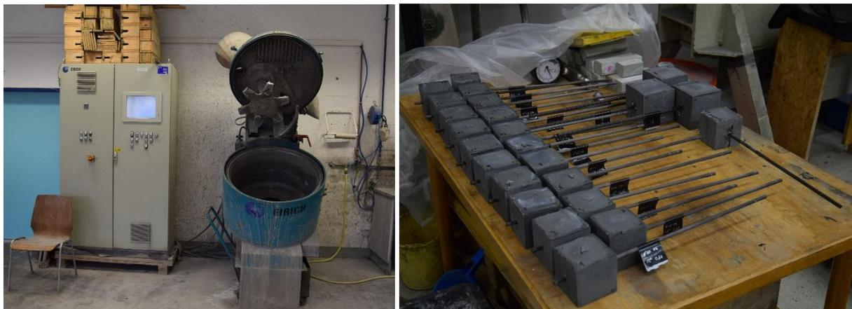
Abbildung 5-7: Zwangsmischer des Instituts für Werkstofftechnologie der TU Wien (links) und die ausgeschalteten Prüfkörper im Labor des Instituts für Tragkonstruktionen
