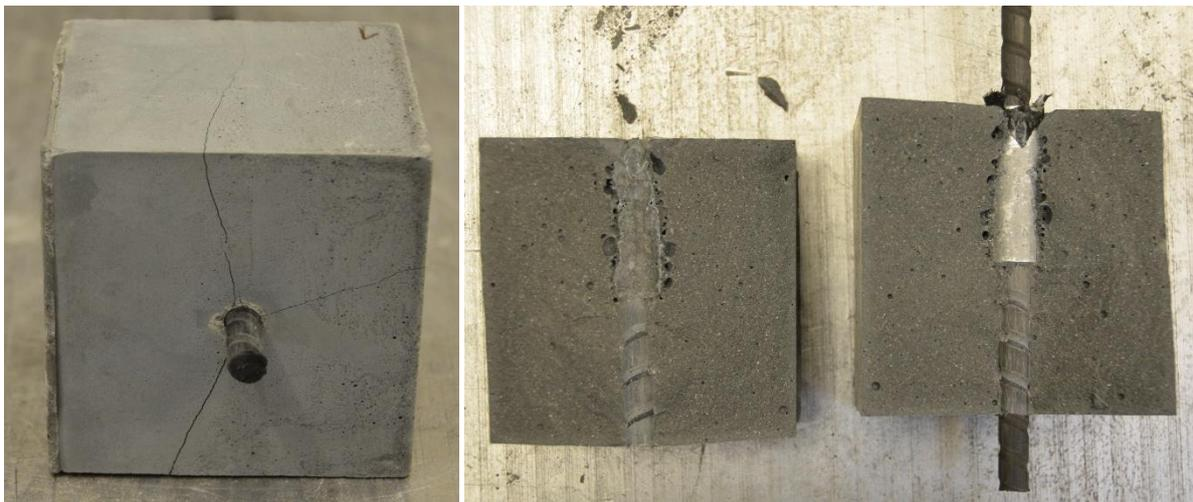
Abbildung 5-23: Spaltrisse im Prüfkörper T1 (links) und nahezu unbeschädigter Stab im Inneren (rechts)
