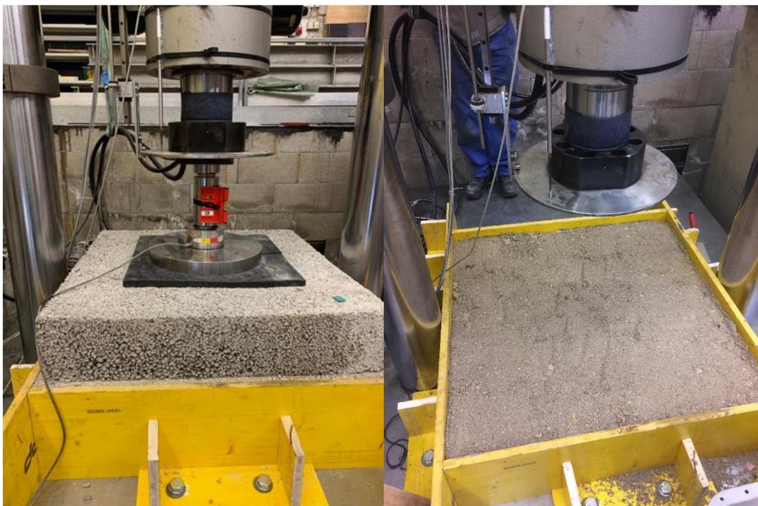
Abbildung 33. Erster Aufbau des Ermüdungsversuchs
