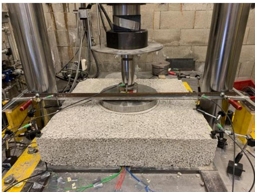
Abbildung 40. Ermüdungsversuch
