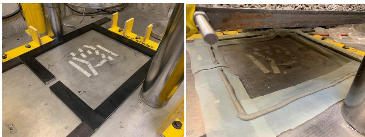
Abbildung 34. Zweiter Aufbau des Ermüdungsversuchs auf Stahlprofilen, Elastomermatten und einer Ausgleichsschicht aus Fliesenkleber
