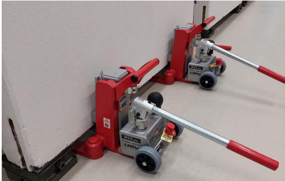
Abbildung 45: Anheben der Betonblöcke ohne Positionsveränderung, e. A.
