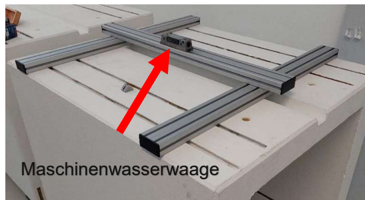
Abbildung 44: Nivellieren der Betonblöcke, e. A.
