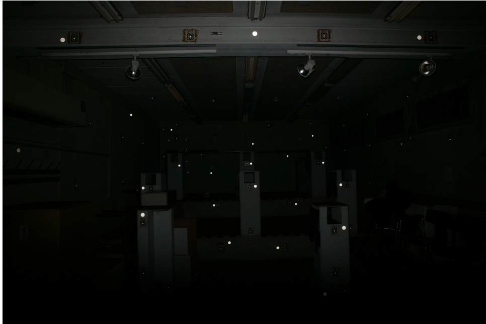
Abbildung 3.3: Kalibrieraufnahme ( \kappa \approx 100^{\text{gon}} ) des 3D-Testfeldes im Messkeller des Instituts
