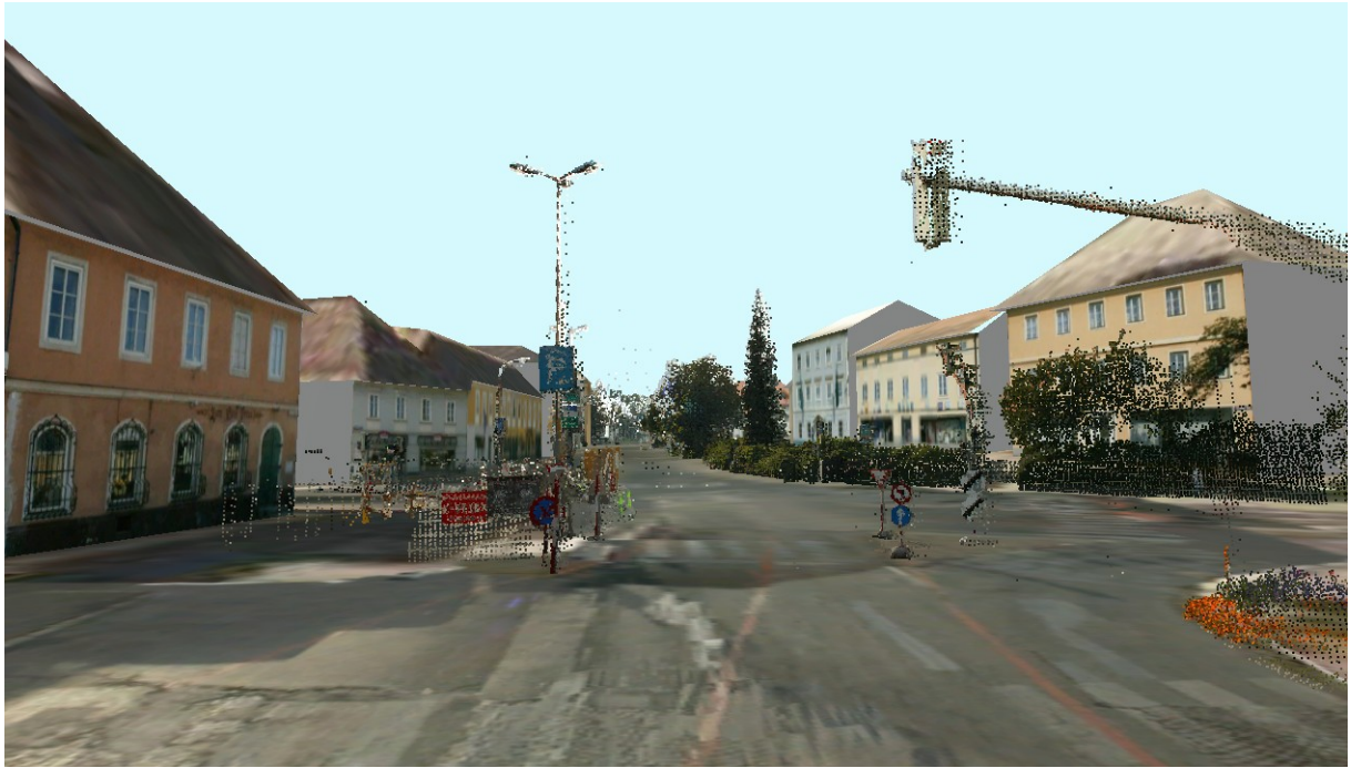
Abbildung 5.13: Visualisierung der eingefärbten georeferenzierten Punktwolke gemeinsam mit abgeleiteten texturierten Gebäudemodellen und texturiertem Boden (nach erfolgter Modellierung durch die Firma Geodata IT)
