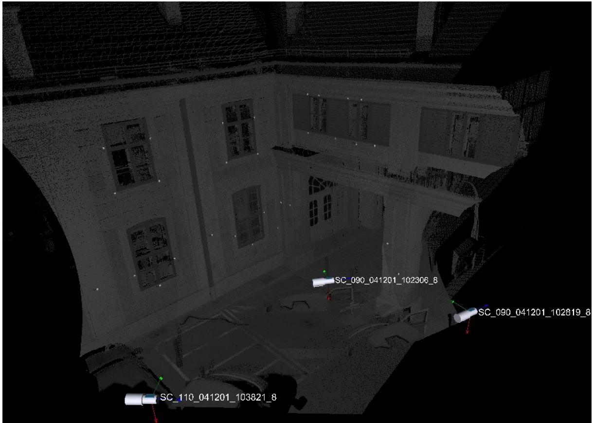
Abbildung 3.12: Kalibrierprojekt mit einem temporären Testfeld bestehend aus 29 Retro-Reflektormarken. 3 Scan-Positionen wurden aufgenommen, die in dieser Darstellung bereits relativ zueinander orientiert sind. Der Grauwert eines Punktes entspricht seinem jeweiligen Intensitätswert.
