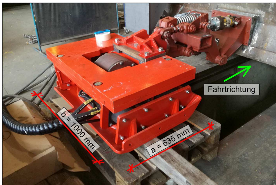
Abbildung 6.6: Abmessungen der Grundplatte des Plattenverdichters; Bauhof der Swietelsky
