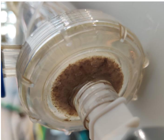
Abbildung 21: Bildung einer Deckschicht an der Feedeingangsseite der Membran bei den Dauerversuchen
