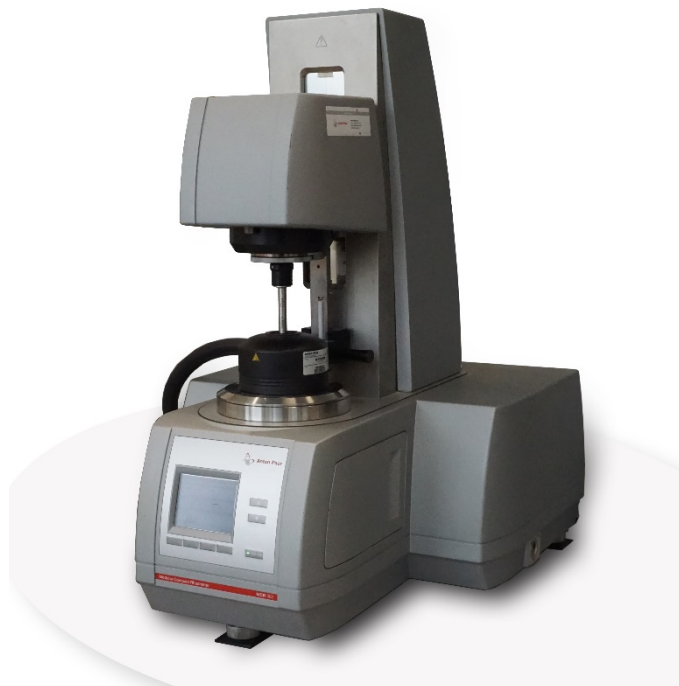
Abb.14 Dynamisches Scherrheometer MCR 302 von Anton Paar
