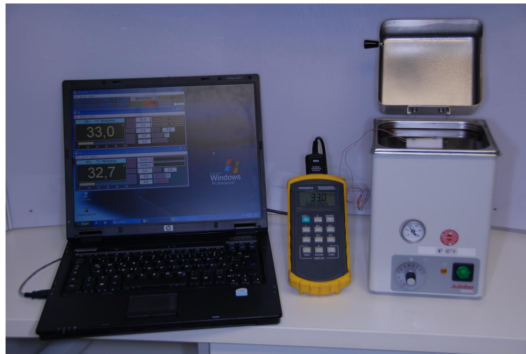
Abbildung 3.4: Das Implantat befindet sich im Wasserbad und die Thermoelemente sind über den Multilogger mit dem Laptop verbunden.
