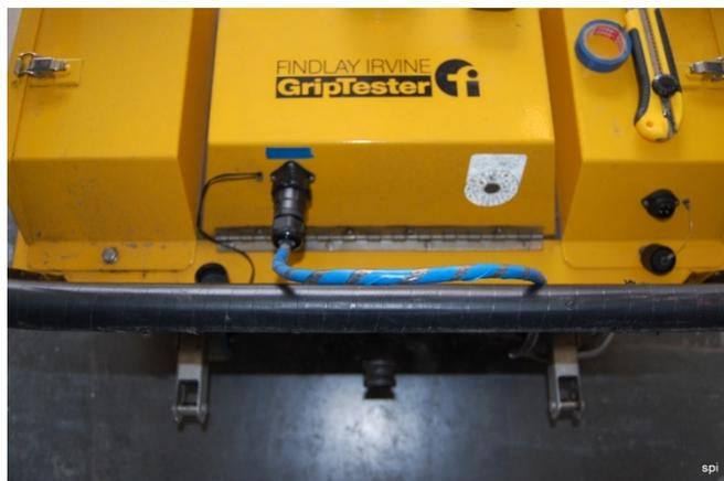
Abbildung 2-3: kurzes blaues Verbindungskabel
