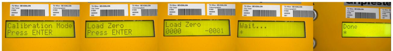
Abbildung 5-11: Kalibrierung Load Zero
