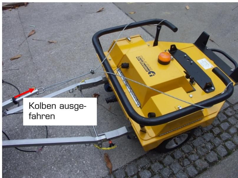
Abbildung 3-9: Montage der Seile
