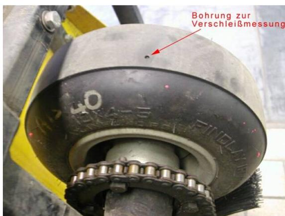
Abbildung 5-7: Bohrung zur Verschleißmessung
