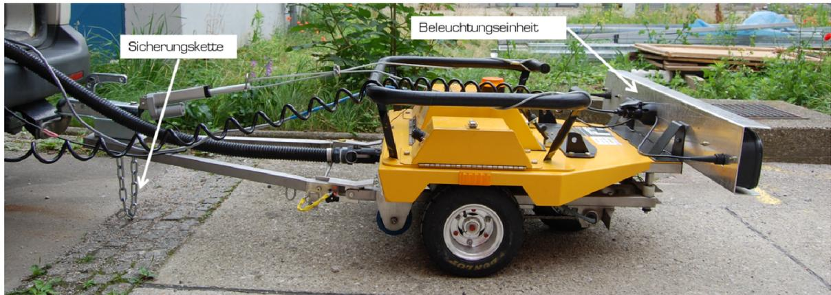
**Abbildung 3-1: Beleuchtung und Sicherungskette GripTester MK2**
