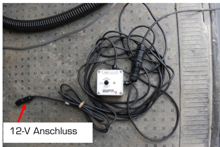
Abbildung 3-10: Steuereinheit Wheellift
