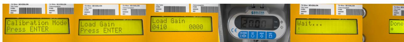
Abbildung 5-14: Kalibrierung Load Gain
