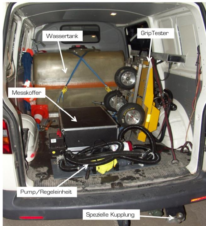
**Abbildung 3-4: Messsystem GripTester MK2**
