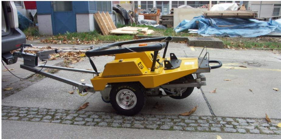
**Abbildung 3-10: Wheellift (entlastetes Messrad)**
