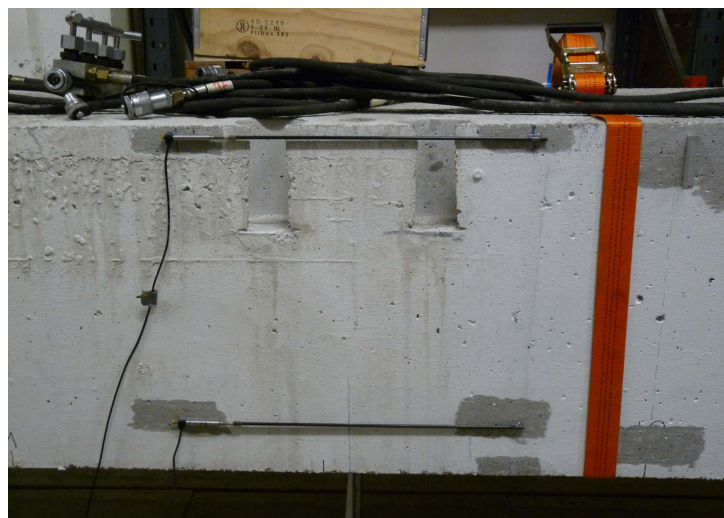
Abbildung 4.33: Anordnung Wegaufnehmer bei Querschnittsschwächung (-0,45 m)
