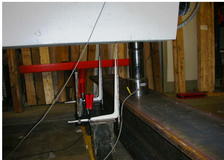
Abbildung 4.15: Anordnung Wegaufnehmer und Kraftmessdosen am Trägerende
