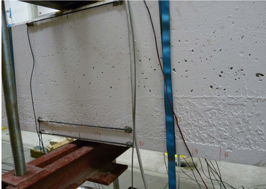
Abbildung 4.19: Anordnung Wegaufnehmer zur Verzerrungsberechnung ZZE
