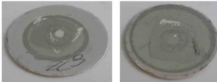
**Abbildung 3-11: Vorder- und Rückseite von Probe C aus neuartigem LTCC-Material**
