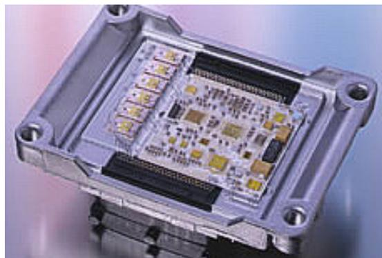
**Abbildung 1-2: Motorsteuerungseinheit [1-3]**
