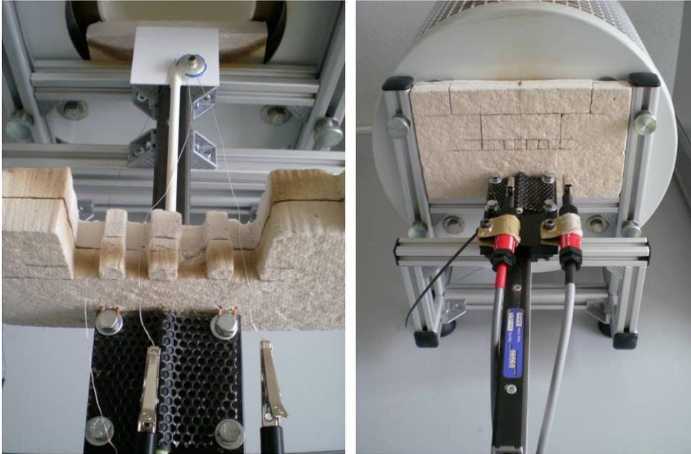
**Abbildung 4-6: Montiertes Hitzeschild am Rohrofen**
