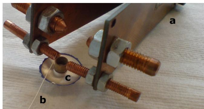
Abbildung 3-14: Elektrodenklemme (a), Ag-Draht (b) und Messinghülse der Probe (c)
