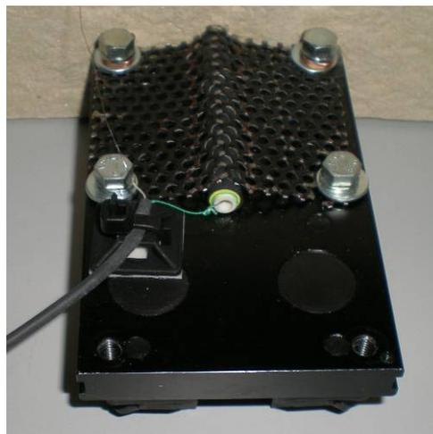
**Abbildung 4-5: Befestigung des Probenträgers an der Trägerplatte mit einem Gitterblech, Schrumpfschläuche (grün und gelb) am Ende des Keramik-Rohres**
