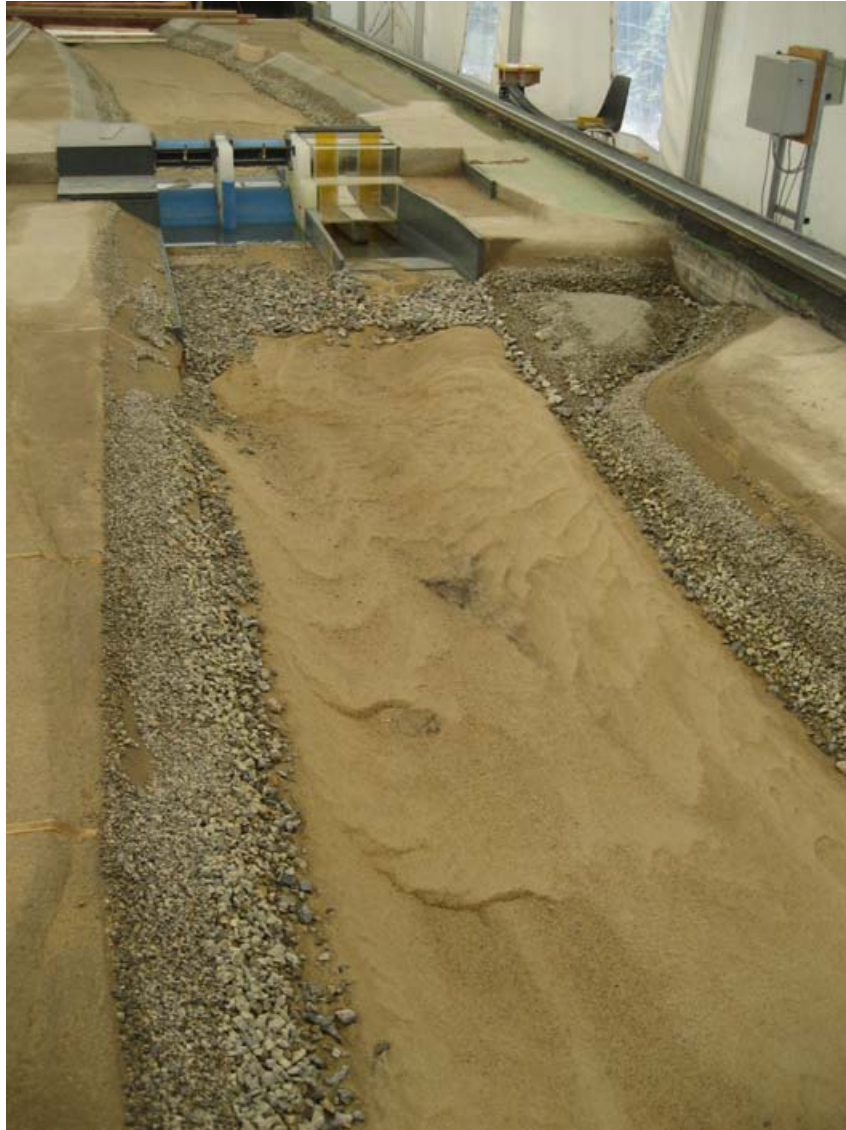
Abbildung 84: Geschiebe- und Sohlenverhältnisse im Auslaufbereich.
