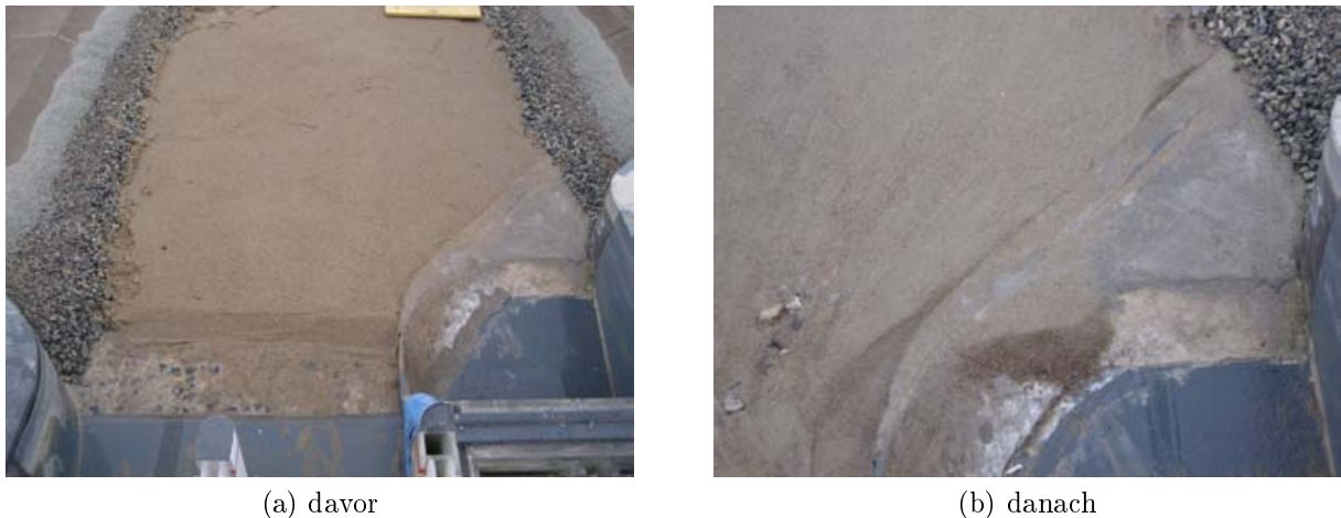
Abbildung 47: Oberwassersohle bei Spülversuch 2
