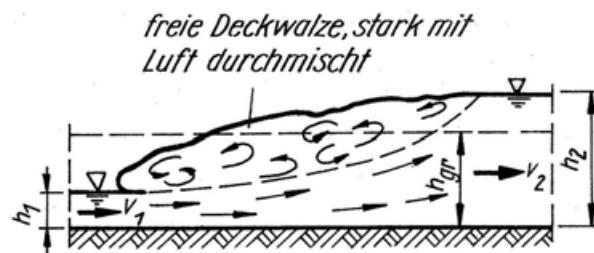
(a) Wechselsprung mit freier Deckwalze, F_r \geq 1,71
