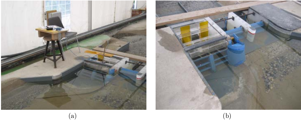
Abbildung 16: Stauhaltung für Messung der Turbinen
