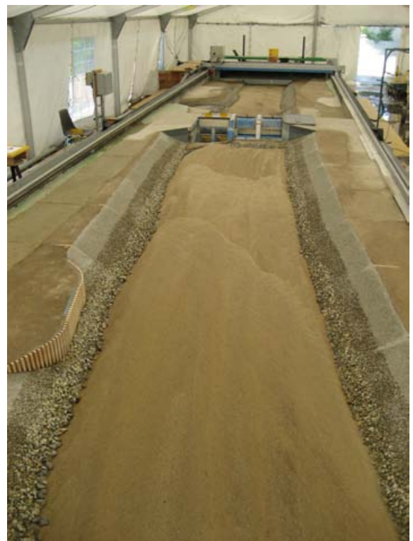
(d) Oberwasserbereich nach der Hochwasserwelle
