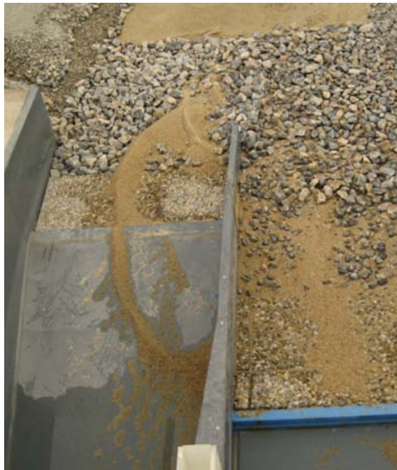
(c) Ablagerungen nach der Hochwasserwelle
