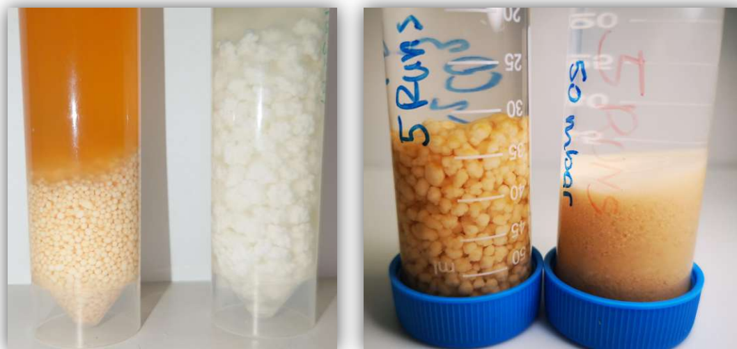
Abbildung 41: Links: Probe links, Zugabe mit der Spritze und rechts mit dem Tropftrichter; Rechts: Probe links, Zugabe mit dem Tropftrichter und rechts mit der Spritze
