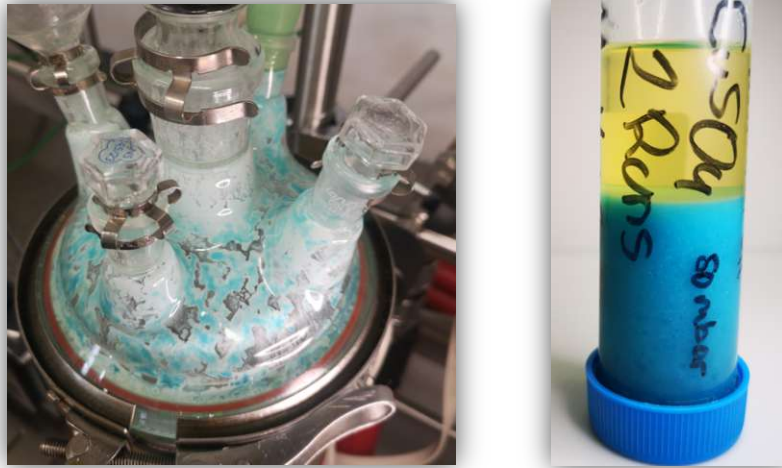
Abbildung 29: Links: Rückstände von Kupfersulfat auf dem Deckel, Rechts: Probe
