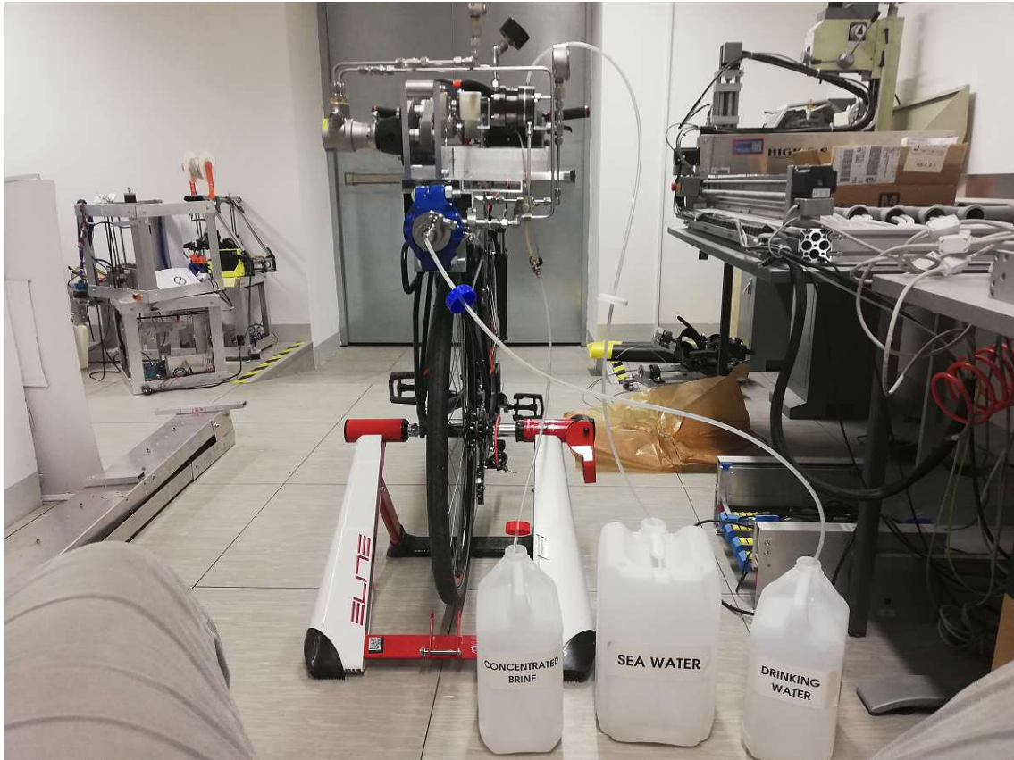
Abbildung 43: Fotografie des Aufbaus der Entsalzungsanlage auf einem Fahrrad
