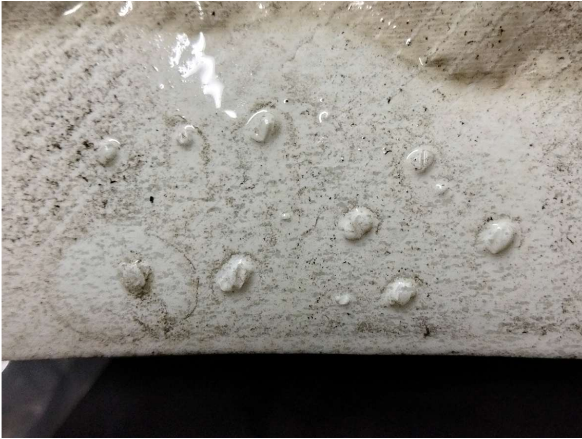
Abbildung 41: Fotografie, die die Ausbeulungen und die metallischen Ablagerungen an der Membran zeigt
