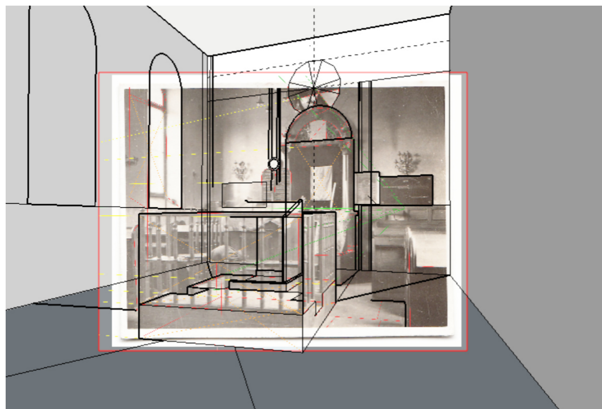
Abb. 4-13: Screenshot aus SketchUP, Rekonstruktion der Positionen und Dimensionen im Innenraum
