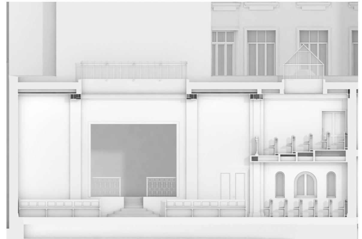
Abb. 11-54: Schnitt mit Blickrichtung Westwand und geöffneter Falttüre zum Turnsaal
